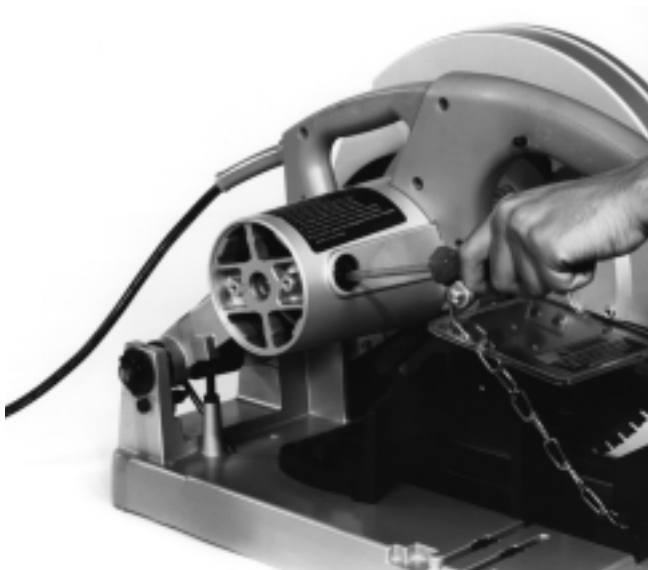
Figure 11 – Retrait des couvercles de balais
