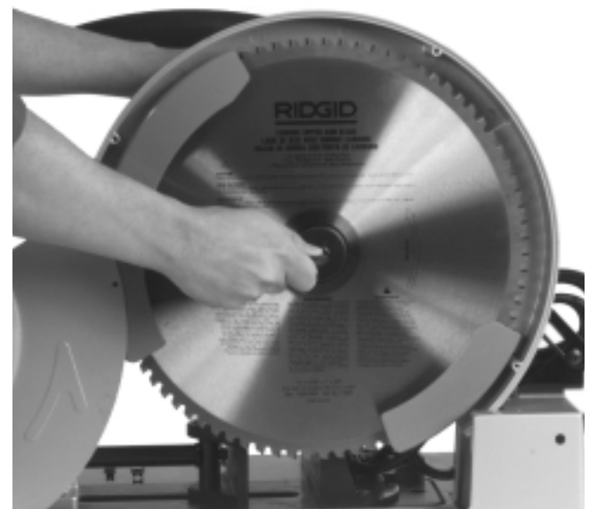
Figure 9 – Installation du disque de tronçonneuse
