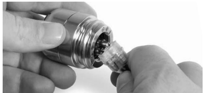
**Figura 38 – Manera como se desenchufa la cámara**
