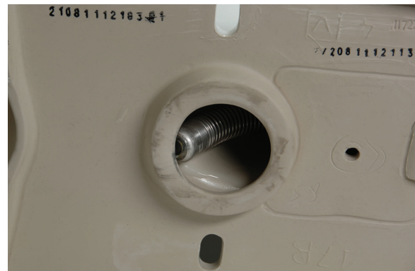
Figura 16 – Cabezal de la cámara bloqueada en una curva
