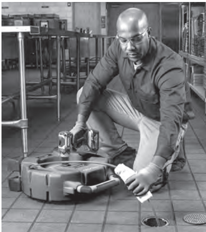
Abbildung 13 – Auftragen von Schmiermittel auf die Spiraleummantelung
