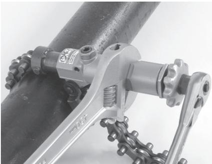
図4 - 陶管カッタの操作 - 手動操作
