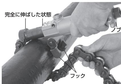
図3 - カッタを完全に伸ばした状態、チェーンの固定
