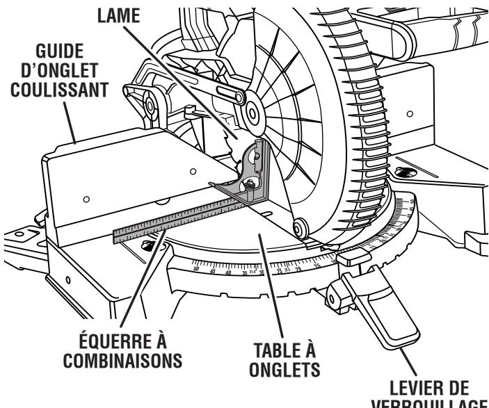
VUE DE LA LAME D'ÉQUERRE AVEC LA TABLE À ONGLETS
