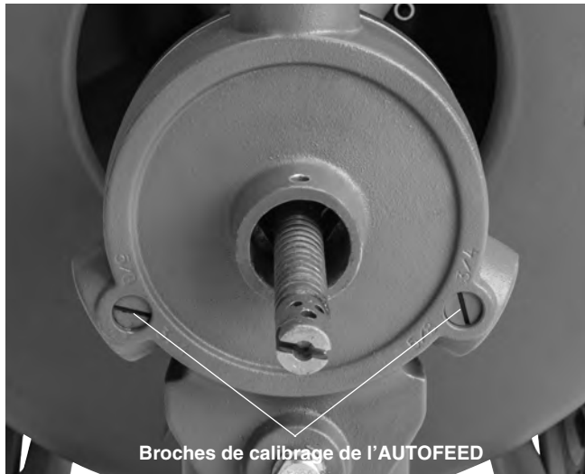
Figure 9 – Broches de calibrage de l'AUTOFEED
