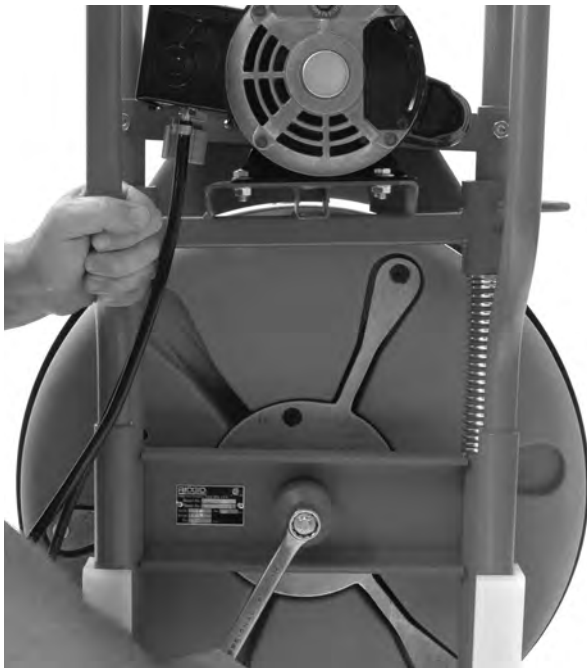
Figure 18 – Retrait du boulon du tambour
