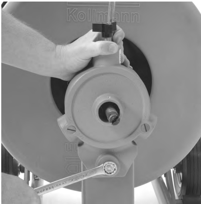
Figura 16 – Extracción del AUTOFEED
