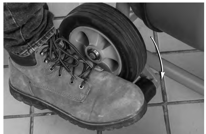
Figure 11 – Déploiement des béquilles
