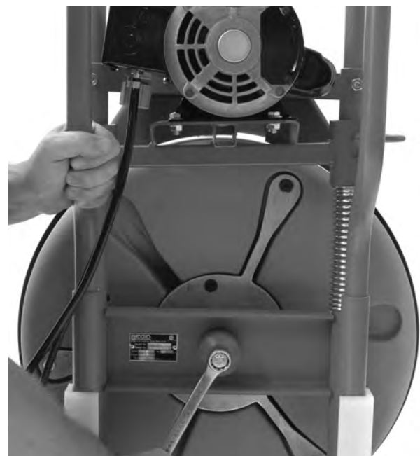
Figura 18 – Extracción del pasador del tambor
