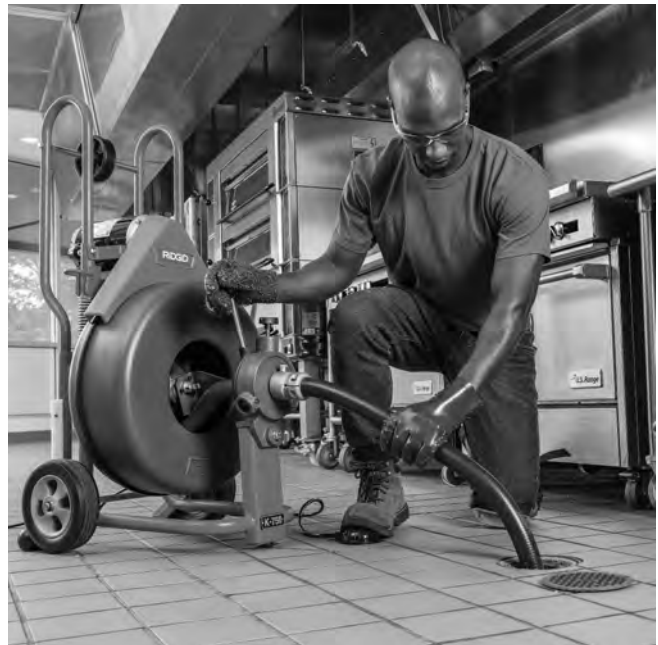
Figura 15 – Uso de la máquina con manguera guía
