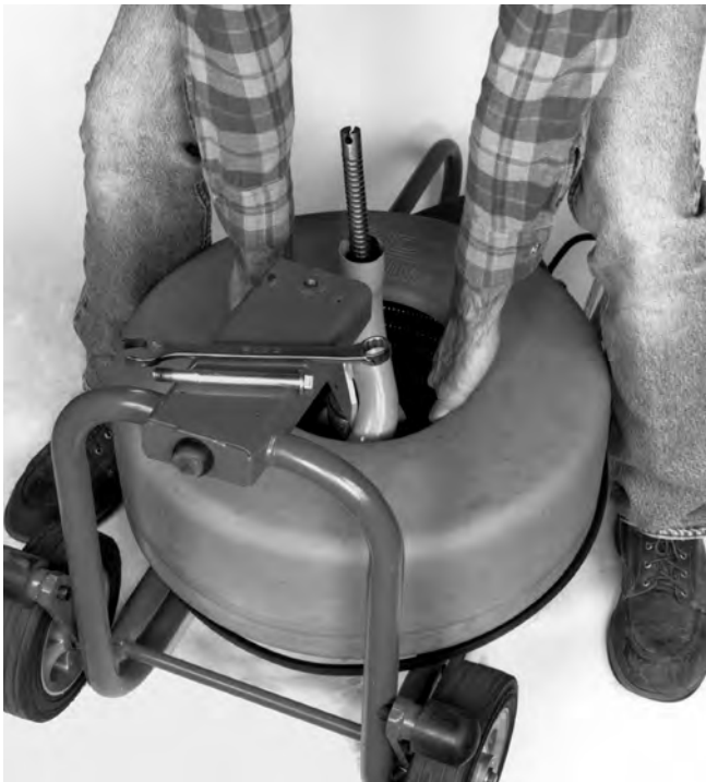
Figure 19 – Dépose du tambour
