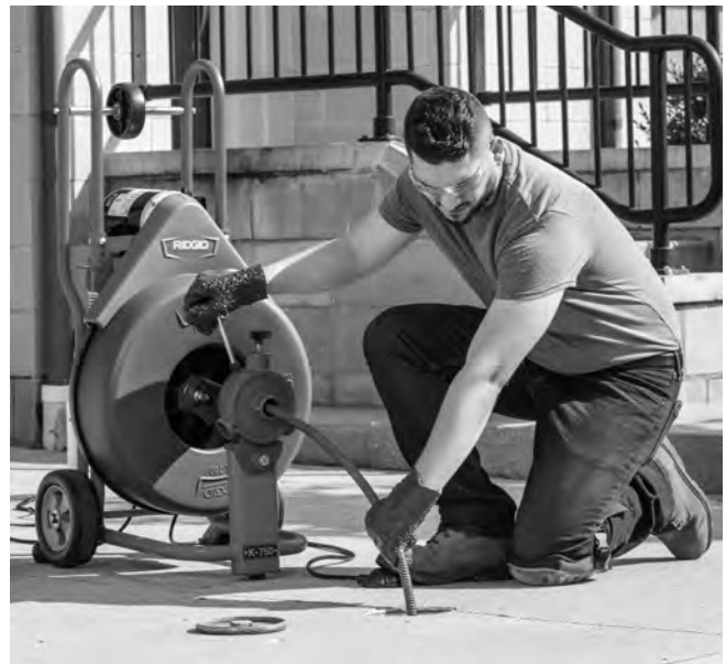
Figura 14 – Funcionamiento de la máquina K-750 con AUTOFEED
