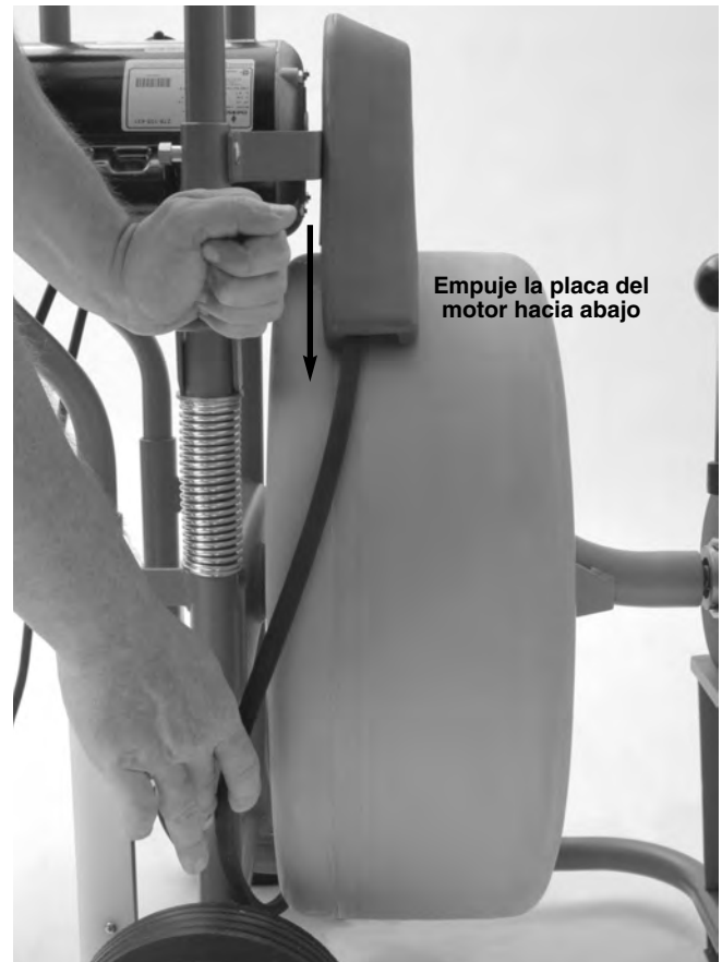
Figura 17 – Cómo aflojar la tensión de la correa
