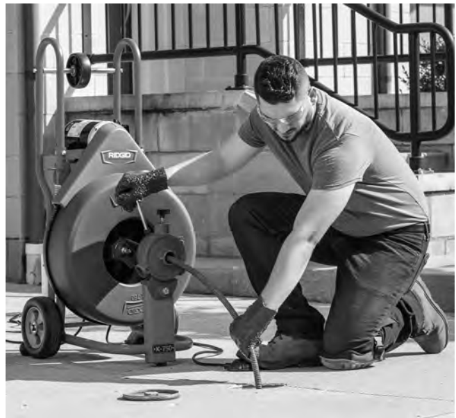
Figure 14 – Utilisation du K-750 avec AUTOFEED
