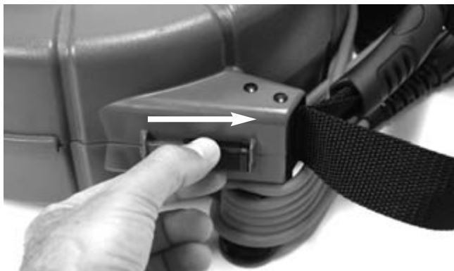
Figuur 4 – microReel-behuizing ontgrendelen
