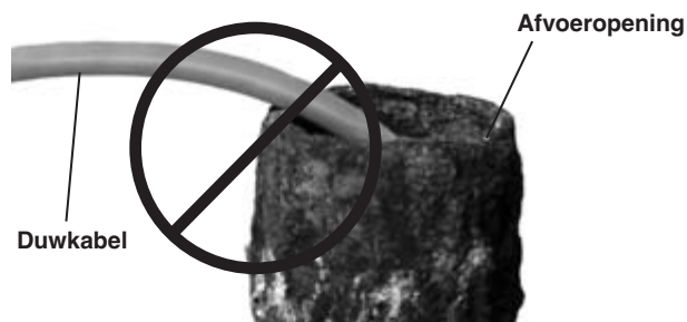
Figuur 23 – Vermijd het trekken in scherpe hoeken
