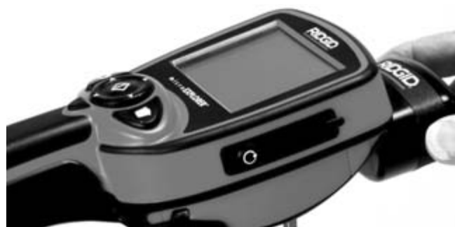
Figuur 14 – Aansluiten van de microEXPLORER-cameramonitor
