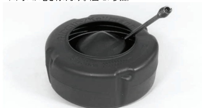
図-21 ケーブルを内部ドラムに装着する時は時計回りに巻く
