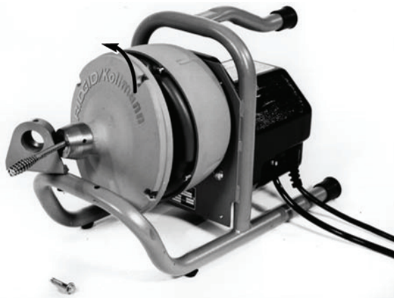
図-19 ドラムフロント部を回転する
