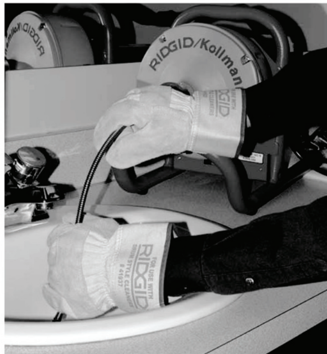
図-11 手動によるケーブルの送り込み
