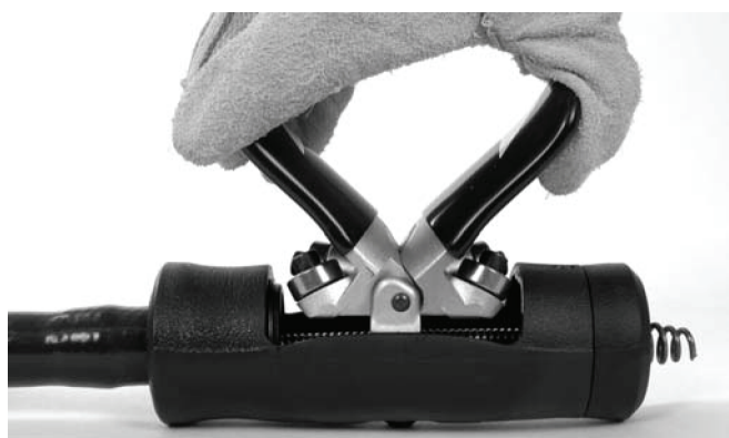
図-5 ケーブルをオートフィードに通す
