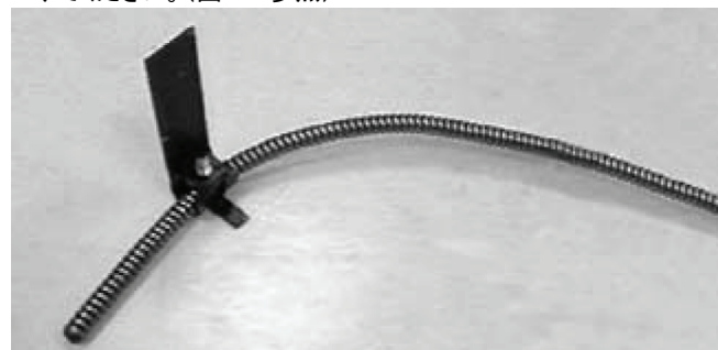
図-20 ケーブルに装着されたトルクアーム (ケーブルは、図で示したように、終端から約 5cm の位置でクランプを取り付け、曲げた形状にします。)
