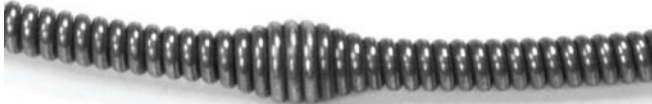
図-12 末端表示が付いた C-13ICSB ケーブル (スピードパンプではケーブル終端から約 1.3m の位置にある)
