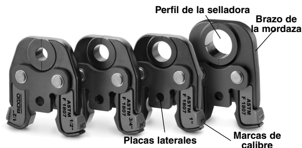
Figura 1 – Mordazas de sellado ASTM F 1807
