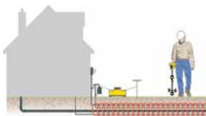
Direktanslut till ledningar för el, vatten och gas.
