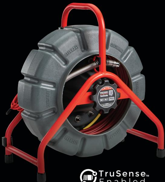
Die RIDGID® SeeSnake® Mini Pro™ liefert das stabilste Bild im Rohr mit digitaler Selbstnivellierung und TruSense™ Technologie. Unser kürzester 25 mm selbstnivellierender Kamerakopf kann harte 90°-Kurven durchfahren und dabei bis zu 61 m (200 ft.) mit mittelsteifem Schubkabel inspizieren. Der Verzicht auf bewegliche Teile im Kamerakopf erhöht die Lebenserwartung des Kamerakopfes erheblich.
