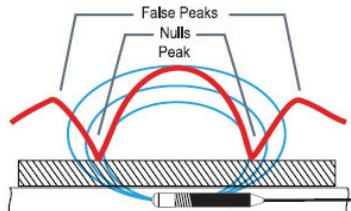
图70：传统定位仪的工作原理（信号发射器点定位）
