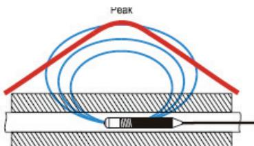
图71：SR-60的工作原理（信号发射器点定位）
