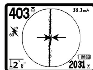
图29：60<sup>th</sup> Hz被动式管线探测显示界面
