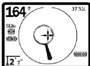
图38：双频定位模式：没有搜索到信号时的图标
