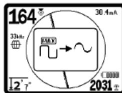
图25：自动削弱信号启动
