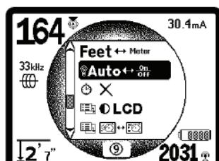
图49：设置背景灯照明模式（开启/关闭/自动）
