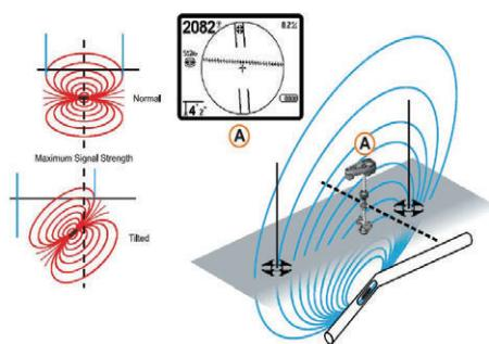
图40：倾斜放置的信号发射器两极与赤道示意
