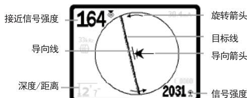
图5：显示内容（管线定位模式）
