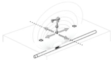
图35：信号发射器的两极和赤道面
