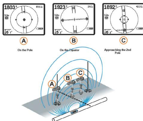
图39：不同位置屏幕定位信息的显示（信号发射器点定位模式）
