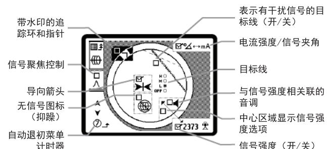
图52：管线定位模式下的参数
