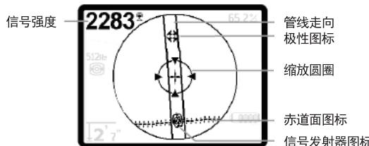
图6：显示内容（信号发射器点定位模式）
