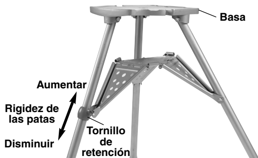
Figura 2 – Ajuste del soporte de la repisa
