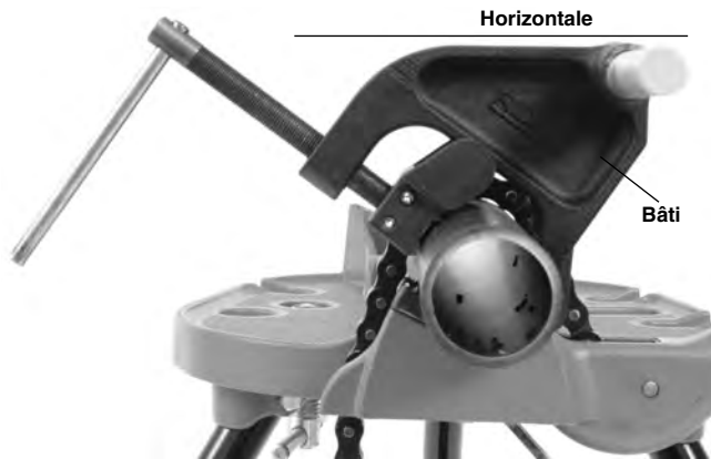
Figure 11A – Positionnement du support de système d'entraînement
