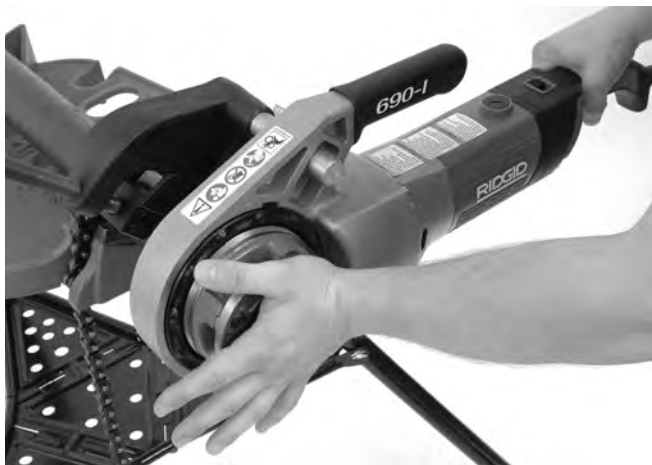
Figura 13 – Inicio del roscado
