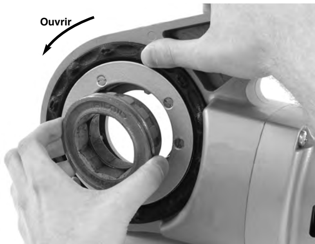
Figure 8 – Installation de l'adaptateur sur la 690-I
