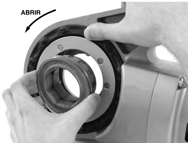
Figura 8 – Montaje del adaptador en la máquina 690-I
