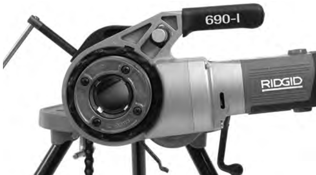
Figure 12 – Orientation appropriée du système d'entraînement
