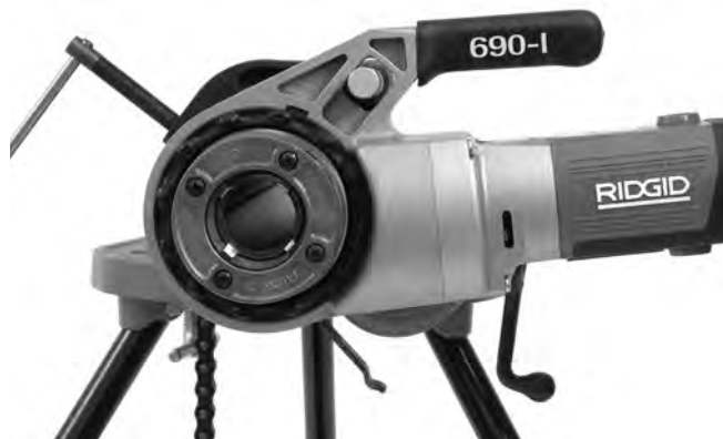
Figura 12 – Orientación correcta del accionamiento motorizado
