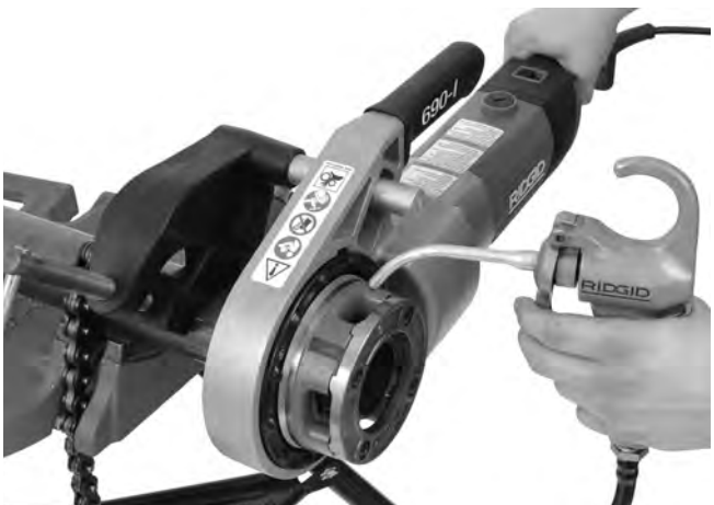
Figura 14 – Roscado de un tubo
