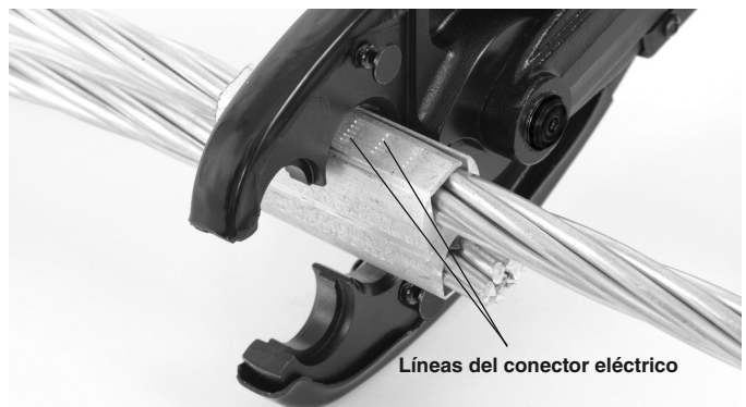
Figure 3 – Alineamiento del conector en el perfil de engarce
