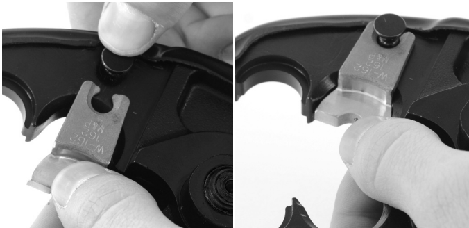
Figure 2 – Installation des matrices dans la tête de sertissage
