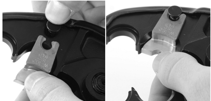
Figure 2 – Colocación de las terrajas en el cabezal engarzador
