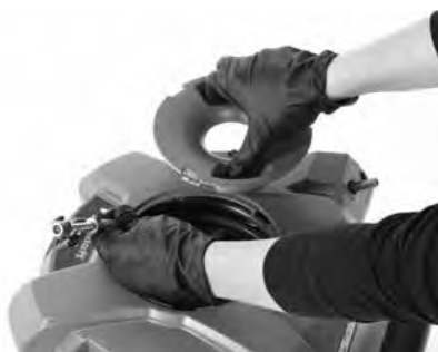
Figur 7B – Tag kædeskraberen/spiralen ud
