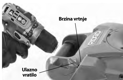
Slika 4 – Postavljanje bušilice na ulazno vratilo
