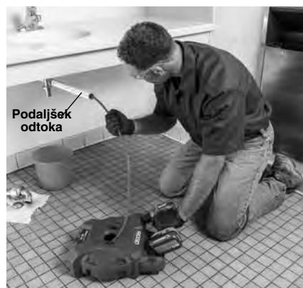
Slika 5 - Primer podaljšanja dostopa do odtoka do 3' od odprtine za kabl na napravi
