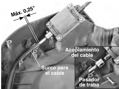
Figura 19 – Instalación de un cable de repuesto
