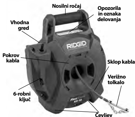
Slika 1A - Stroj za čiščenje odtokov RIDGID® K9-12 FlexShaft
