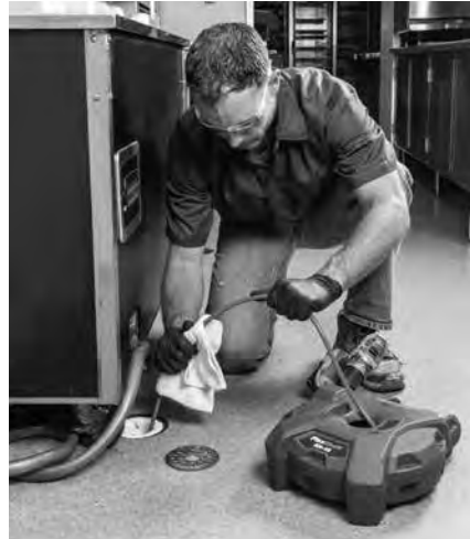
Rysunek 15 – Nakładanie środka smarnego na osłonę wałka giętkiego
