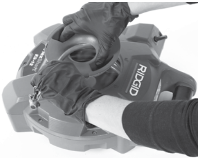
Slika 7C – Provođenje sajle kroz otvor zatvarača Slika 7 – Vađenje lančanog mlata iz bubnja
