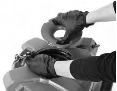
Kuva 7B – Vedä ketjuhakkuri/jousi ulos
