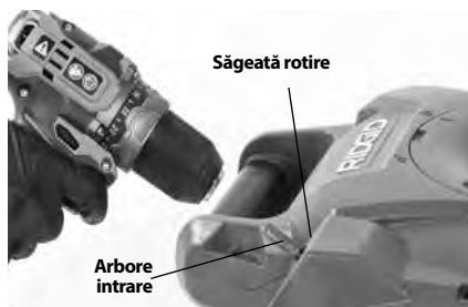
Figura 4 – Atașarea bormașinii pe axul acesteia
