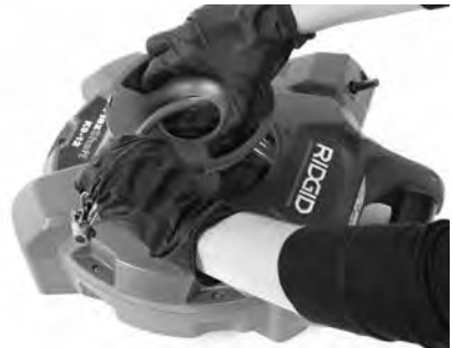
Abbildung 7C - Durchführen der Spirale durch das Deckelloch
