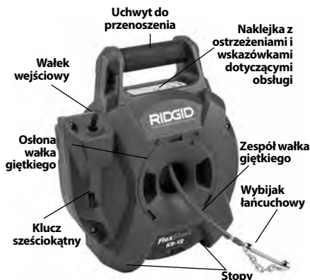
Rysunek 1A – Maszyna do przepychania odpływów RIDGID® K9-12 FlexShaft
