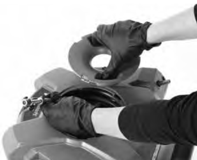
Obrázok 7B – Vytiahnutie reťazového klopädla/kábla
