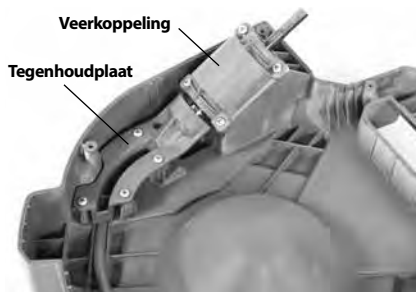
Figuur 18 – Bovenste behuizing afvoerontstopper verwijderd
