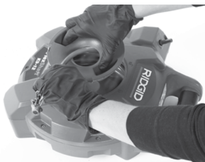
Slika 7C - Provucite sajlju kroz otvor na poklopcu Slika 7 - Skidanje lančanog udarača sa bubnja
