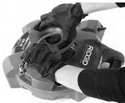
Figur 7C – Før spiralen gennem hullet i dækslet
