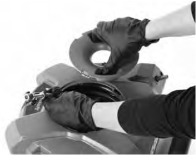
Figure 7B – Retrait du dégorgeoir/du câble
