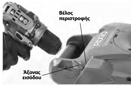
Εικόνα 4 – Σύνδεση δρανάπου στον άξονα εισόδου
