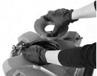
Abbildung 7B - Herausnehmen des Kettenschleuderkopfes/der Spirale
