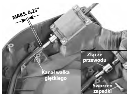
Rysunek 19 – Montaż zamiennego wałka giętkiego
