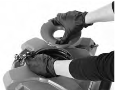
Rysunek 7B – Wyciąganie wybijaka łańcuchowego/wałka giętkiego
