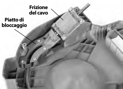
Figura 18 - Alloggiamento superiore della stasatrice rimosso
