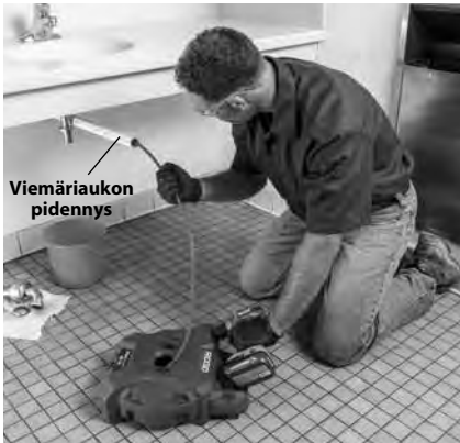
Kuva 5 – Esimerkki viemäriaukon pidentämi- sestä 3' päähän koneen jousiaukko
