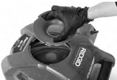
Figura 7A - Rimuovere il coperchio
