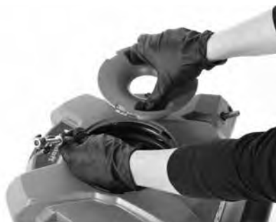
Figura 7B – Recuperação do golpeador com corrente/cabo
