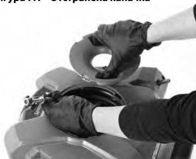
Фигура 7B – Изваждане на ударна верига/кабел
