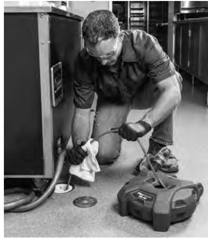
Figura 15 – Applicazioni di lubrificante nella Guaina del cavo
