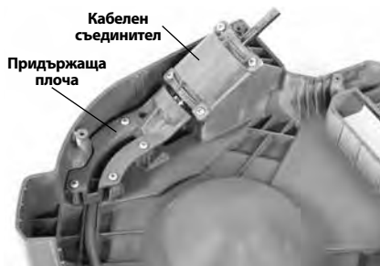
Фигура 18 – Отстранена горна част на корпуса на машината за почистване
