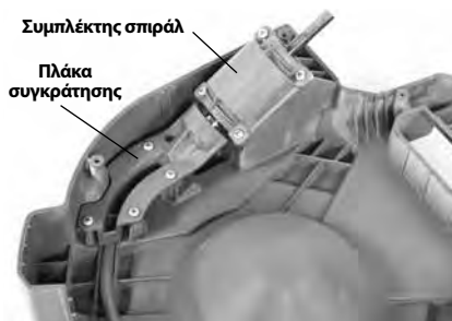
Εικόνα 18 – Το επάνω περίβλημα του μηχανήματος απόφραξης αποχετεύσεων έχει αφαιρεθεί
