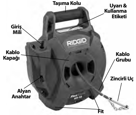
Şekil 1A – RIDGID® K9-12 FlexShaft Kanal Açma Makinesi
