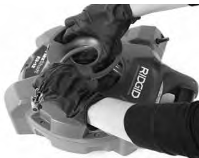
Фигура 7C – Подаване на кабел през отвора на капачката
