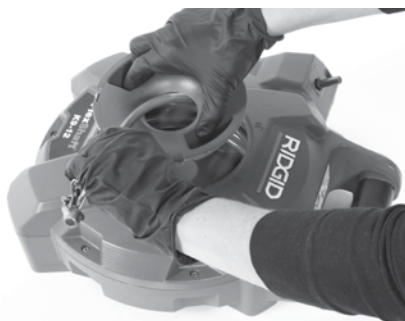
Slika 7C – Napeljite kabel skozi odprtino pokrova
