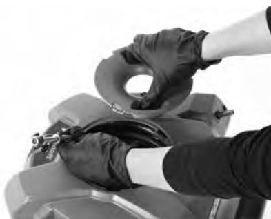
Εικόνα 7Β – Ανάσυρση αποφρακτικής κεφαλής αλυσίδας/σπιράλ
