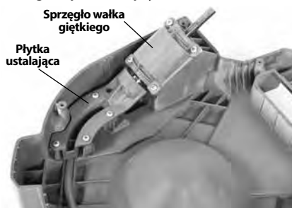
Rysunek 18 – Zdjęta górna obudowa maszyny do przepychania odpływów
