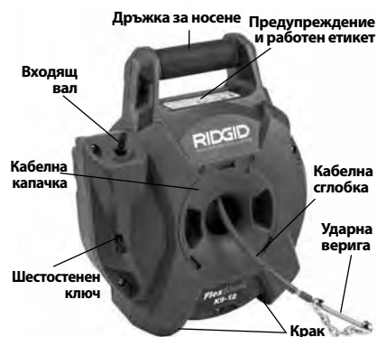
Фигура 1А – Машина за почистване на канали RIDGID® K9-12 FlexShaft
