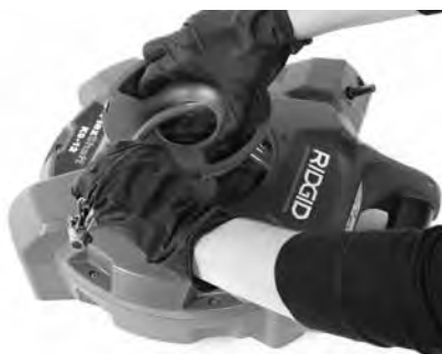
Εικόνα 7C – Τροφοδότηση του σπιράλ μέσω της οπής καπακιού
