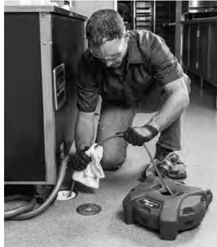
Figur 15 – Applicera smörjmedel på spiralhöljet
