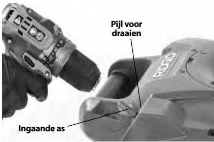
Figuur 4 – De boormachine aan de ingaande as bevestigen
