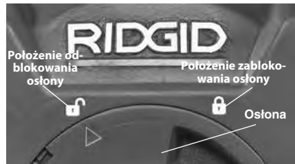
Rysunek 6 – Odblokowywanie osłony
