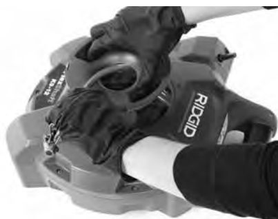
Figura 7C – Introdução do cabo através do orifício da tampa
