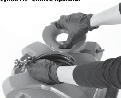
Рисунок 7В - Извлечение цепи молотилки/троса
