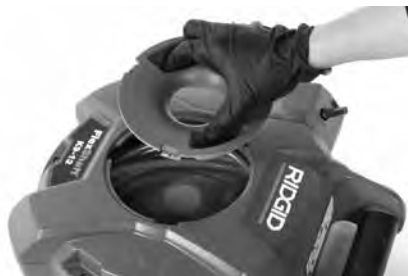
Slika 7A – Odstranite pokrov
