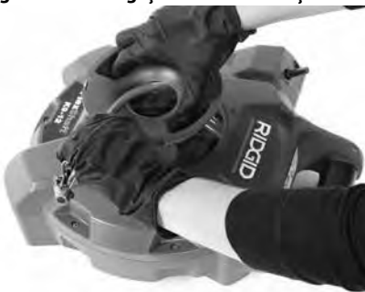
Figura 7C – Introduceți cablul prin orificiul capacului
