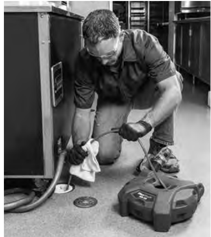
Şekil 15 – Kablo Kılıfına Yağlama Maddesi Uygulama
