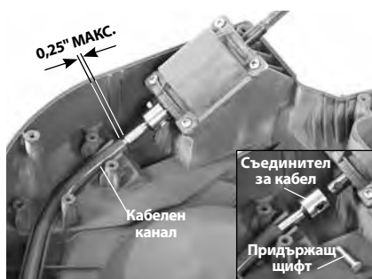
Фигура 19 – Монтиране на кабел за замяна
