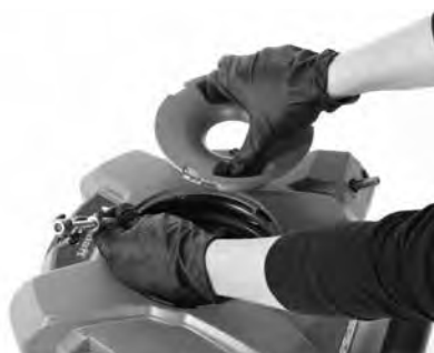
Slika 7B – Povlecite spiralno žagasto rezilo/kabel
