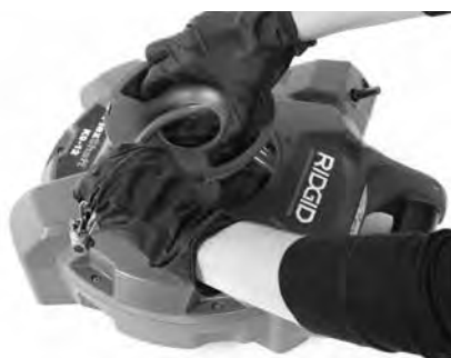
Obrázek 7C – Kabel protáhněte otvorem ve víčku kabelu
