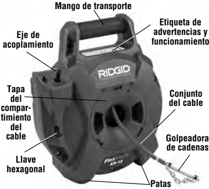
Figura 1 A – Limpiadora de desagües FlexShaft K9-12 de RIDGID®
