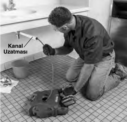
Şekil 5 - Makinenin Kablo Çıkışının 3' İçerisine Kanalın Erişimine Doğru Uzatılmasının Örneği
