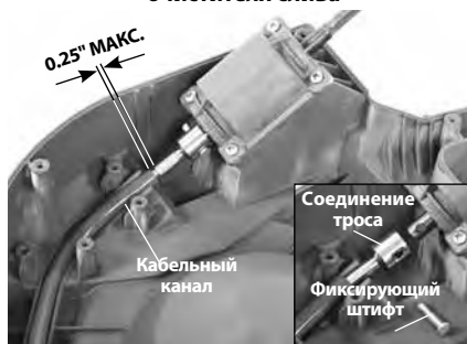
Рисунок 19 - Установка сменного кабеля
