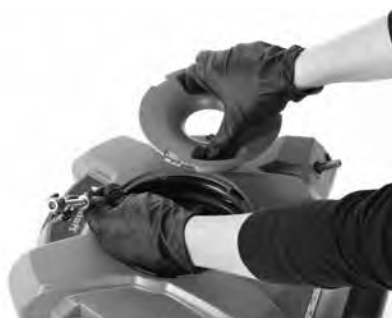
Slika 7B - Skinite lančani udarač/sajlu
