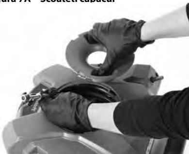
Figura 7B – Extrageți bătătorul cu lanț/cablul
