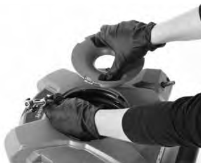
Slika 7B – Vađenje lančanog mlata / sajle
