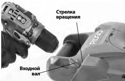
Рис. 4 - Крепление дрели к входному валу
