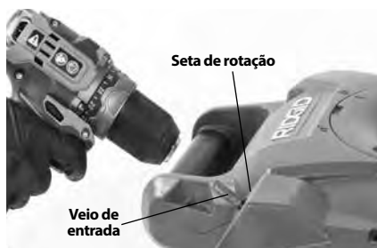
Figura 4 – Fixação da broca ao veio de entrada
