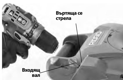
Фигура 4 – Прикачване на бормашина към входящия вал
