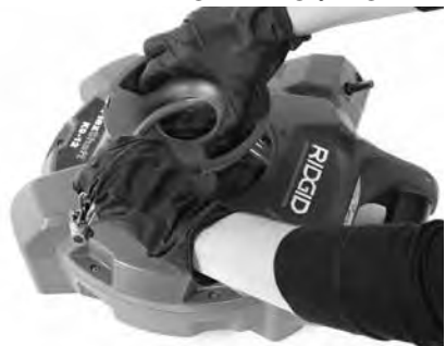
Rysunek 7C – Przeprowadzanie wałka giętkiego przez otwór w osłonie
