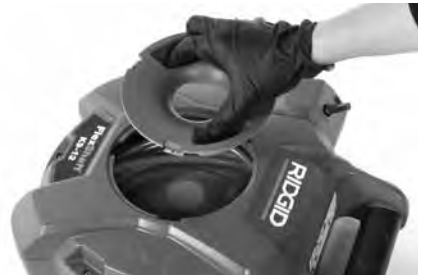
Figuur 7A – De afdekking verwijderen
