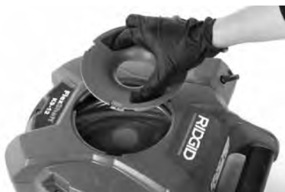
Figura 7A – Remoção da tampa
