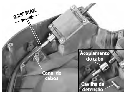
Figura 19 – Instalação do cabo de substituição
