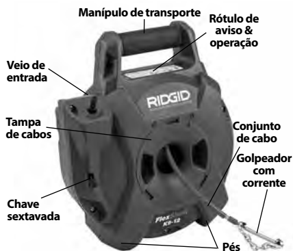
Figura 1A – Máquina de limpeza de tubagens FlexShaft RIDGID®
