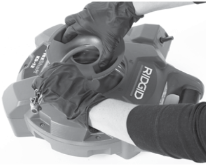
Kuva 7C – Syötä jousi kannen reiän läpi Kuva 7 – Ketjuhakkurin vetäminen kelalta
