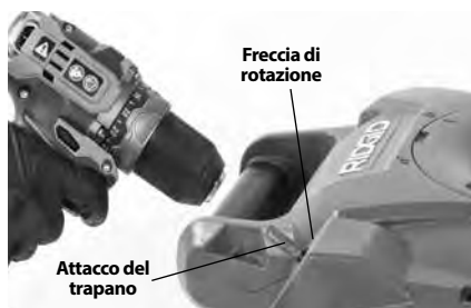
Figura 4 - Collegamento del trapano al perno di attacco
