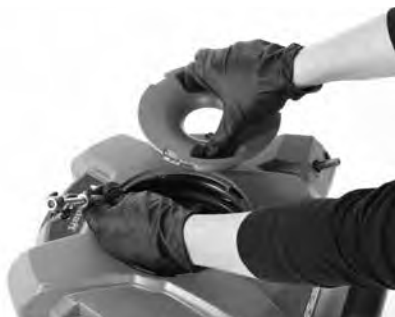
Obrázek 7B – Vytáhněte řetězový omítací nástroj / kabel
