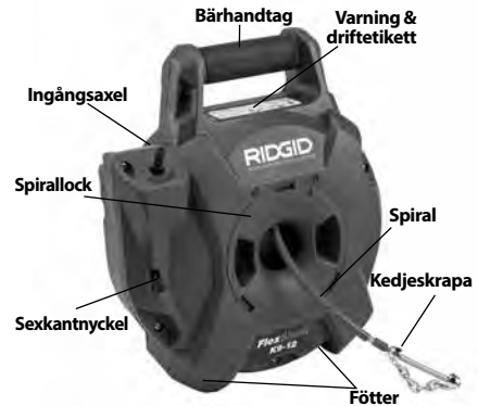
Figur 1A – RIDGID® K9-12 FlexShaft avloppsrennare
