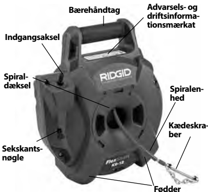
Figur 1A – RIDGID K9-12 FlexShaft-afløbsrensemaskine
