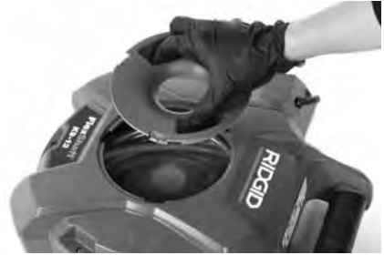
Abbildung 7A - Entfernen des Deckels
