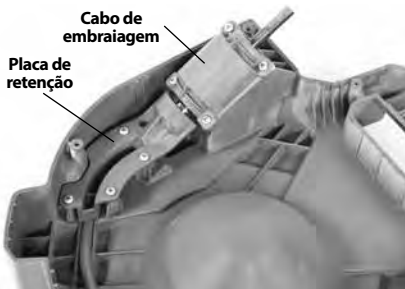
Figura 18 – Alojamento superior da máquina de limpeza de tubagens removido
