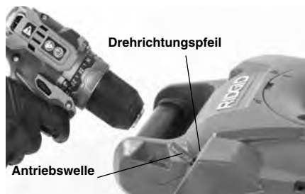
Abbildung 4 – Befestigen des Bohrers an der Antriebswelle
