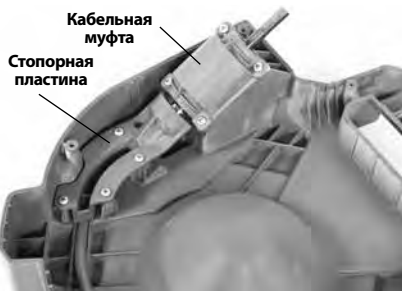
Рисунок 18 - Снятие верхнего корпуса очистителя слива
