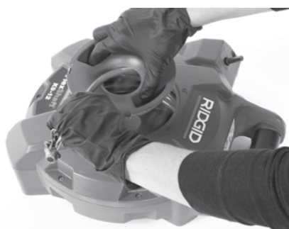
Figur 7C – mata spiralen genom lockhålet Figur 7 – Hämta kedjeskrapan från trumman
