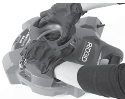
Figuur 7C – De veer door de opening in de afdekking leiden
