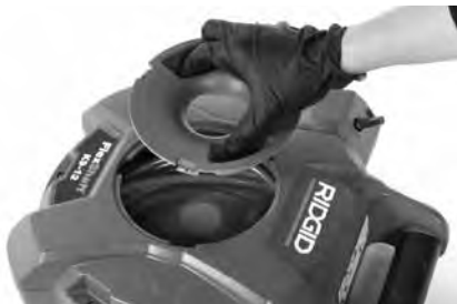
Εικόνα 7Α – Αφαίρεση του καπακιού
