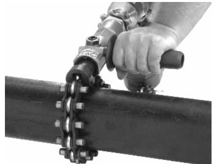
Figure 5 – Utilisation du coupe-tubes à l'aide d'une clé choc
