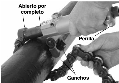
Figura 3 – Cortadora completamente abierta y enganche de la cadena
