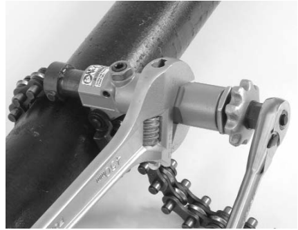
Figure 4 – Utilisation manuelle du coupe-tubes à chaîne
