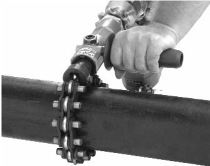
Figura 5 – Funcionamiento de la Cortadora de tubos cloacales impulsada por una herramienta de impacto
