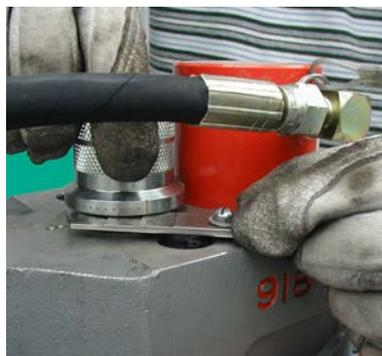
その状態で深さナットと本体の間にゲージを挟み、ゲージにナットが触れるまでナットを締め、ゲージを抜きます。ゲージは加工サイズ別に段差が付いています。
