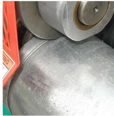
溝を均等につける為、ポンプを終えてからパイプを3~4回転させます。終了後、スイッチをOFFにし、ポンプのバルブを開放します。パイプを注意深く機械から取外して下さい。
