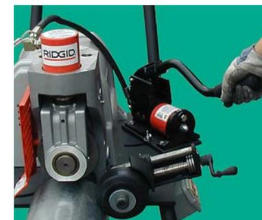
電源プラグを 100V につなぎ、機械のスイッチを ON にします。同時にポンプのハンドルを小さなストロークでパイプ 1 回転につき 1~2 回上下させます。あまり大きなストロークで上下させないで下さい。
