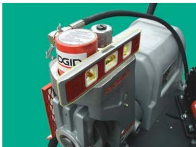
付属の水平器を使用して、機械を出来るだけ水平になるように設置して下さい。
