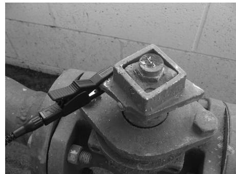
Abbildung 7: Anschließen des ST-305 an eine Leitung
