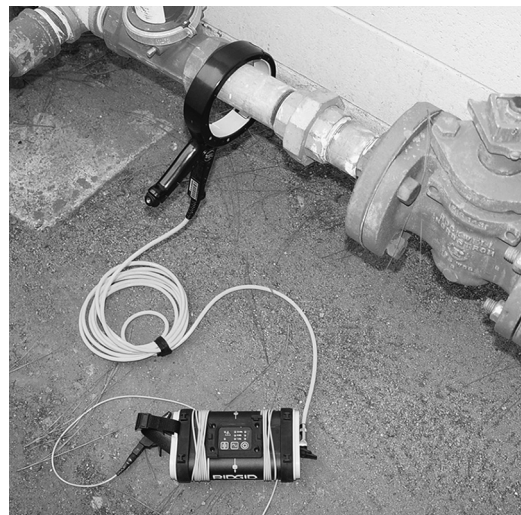
Abbildung 9: An einem Leiter angebrachte Induktionsklammer
