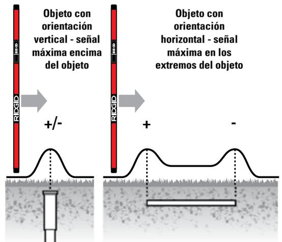
Señales y polaridad de objetos con orientación vertical y horizontal
