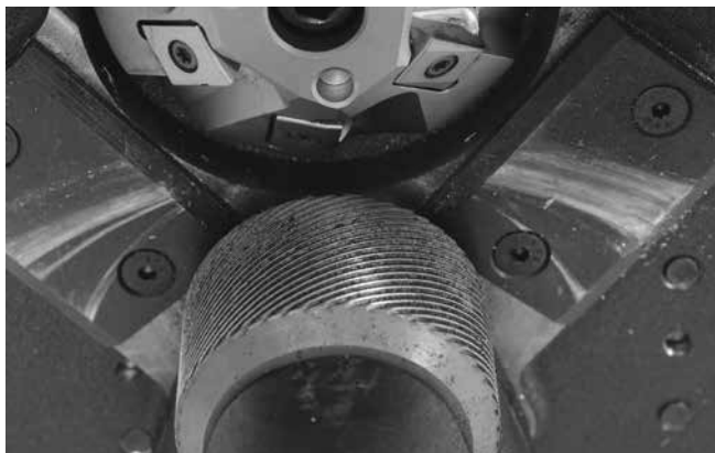
Slika 22 – Čiste kvržice pogonskog točkica
