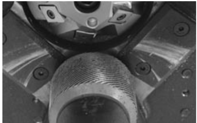
Figura 22 – Superficie moleteada del rodillo de mando, limpia
