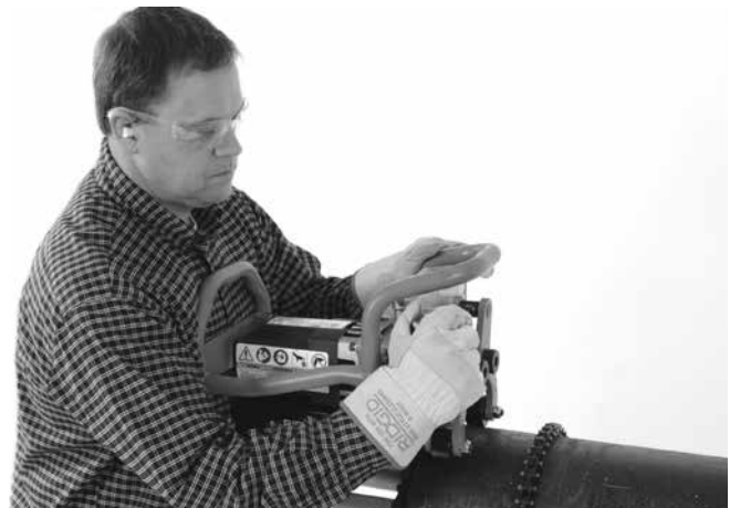
Abbildung 17A – Klemmschraube handfest anziehen
