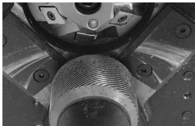
Figura 22 – Pulire le zigrinature del Rullo di trasmissione
