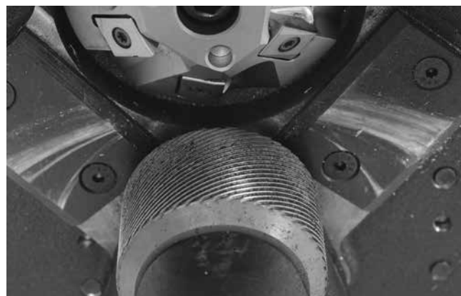
Kuva 22 – Puhdista syöttörullan pykälät
