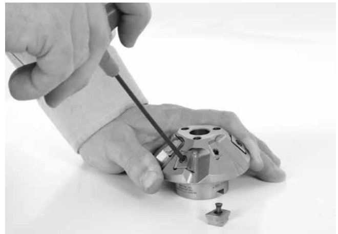
Figura 24 – Sostituzione degli Inserti della taglierina
