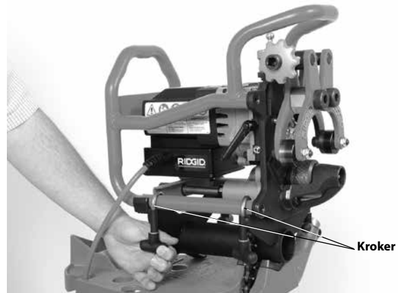
Figur 9 – Feste fasemaskinen til adapteren
