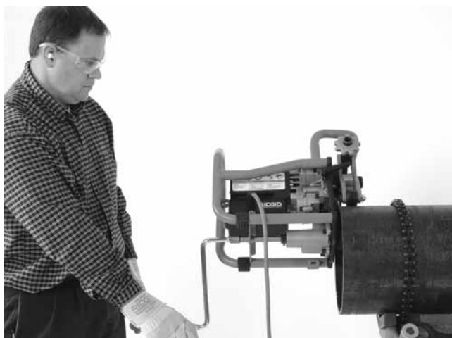
Figur 20A – Affasningsproces (fast arbejdsemne/ bevægeligt affasningsværktøj)
