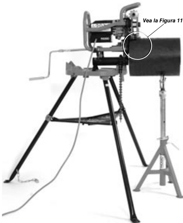
Figura 12 – Biseladora fija, tubo corto y un solo soportatubos
