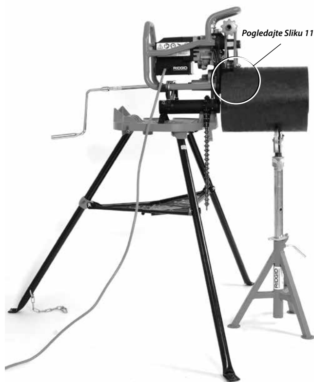
Slika 12 – Fiksiran alat, kratka cijev, jedno postolje za cijev
