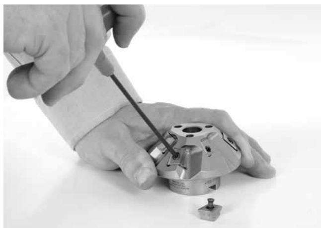
Εικόνα 24 – Αντικατάσταση κοπτικών ενθέτων
