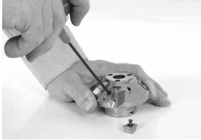
Şekil 24 – Kesici Bagaların Değiştirilmesi
