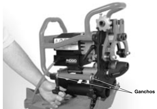
Figura 9 – Conexión de la biseladora con el adaptador
