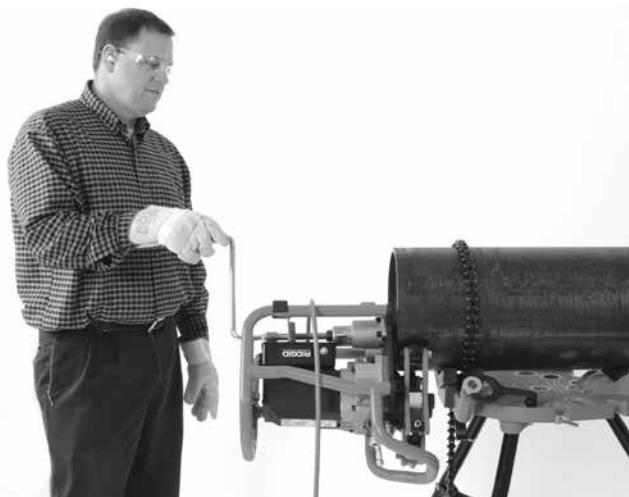
Slika 20B – Operacija obaranja ivica (fiksirani radni komad/pokretni alat za obaranje ivica)
