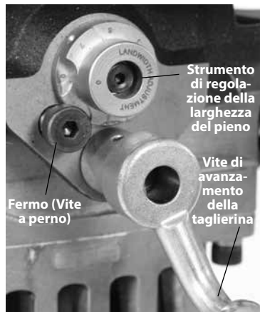
Figura 18 – Impostazione dello Strumento di regolazione della larghezza del pieno
