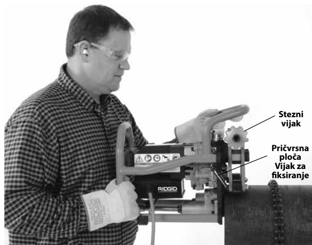
Slika 15A – Postavljanje alata za upuštanje rubova na cijev
