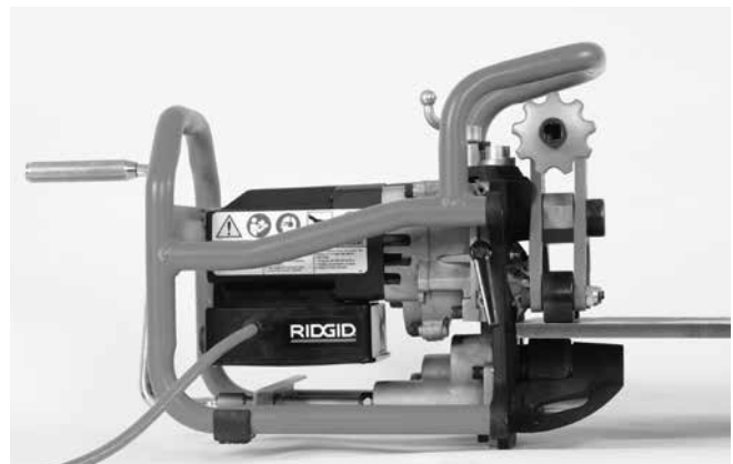
Figur 16B – Montera avfasaren på plåten
