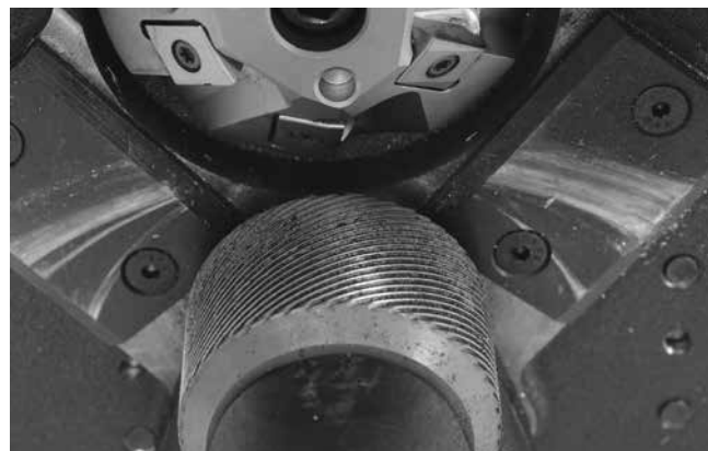
Slika 22 – Čisti utori pogonskog valjka
