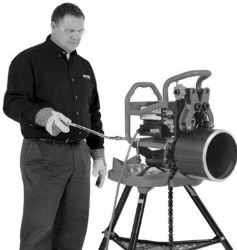
Figura 20C – Operação de Biselagem (Biselador Fixo/ Tubo Rotativo)
