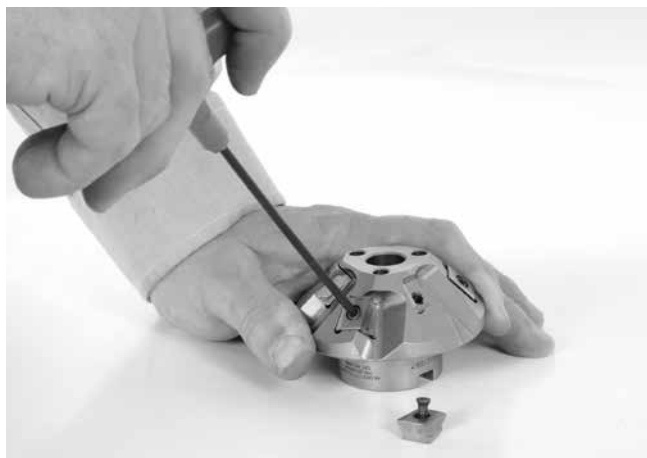
Rys. 24 – Wymiana płytek wieloostrowych
