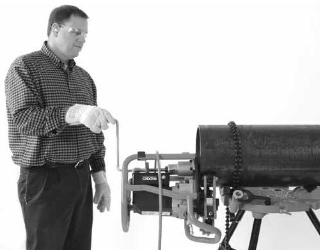
20В-сурет – Қиғаш кесу әрекеті (Тұрақты жұмыс нысаны/Қиғаш кесу құралын жылжиты)
