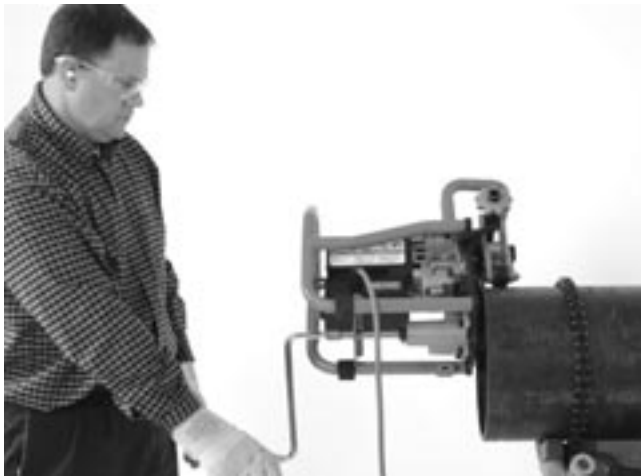
Figure 20A – Biseautage en cours (pièce fixe/machine mobile)
