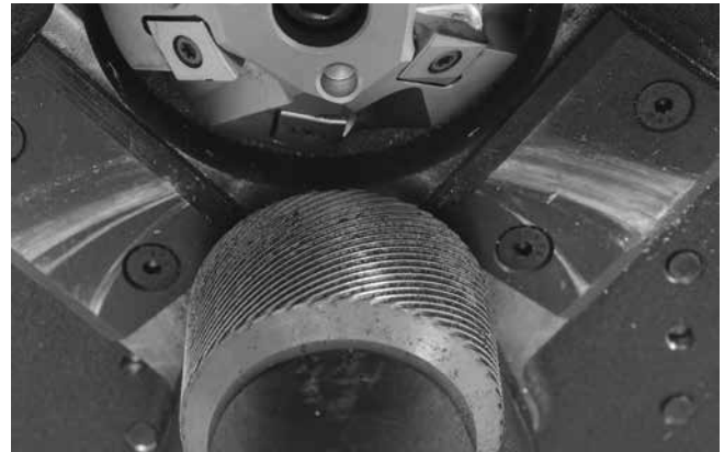
Figur 22 – Rengör drivrullens räfflor
