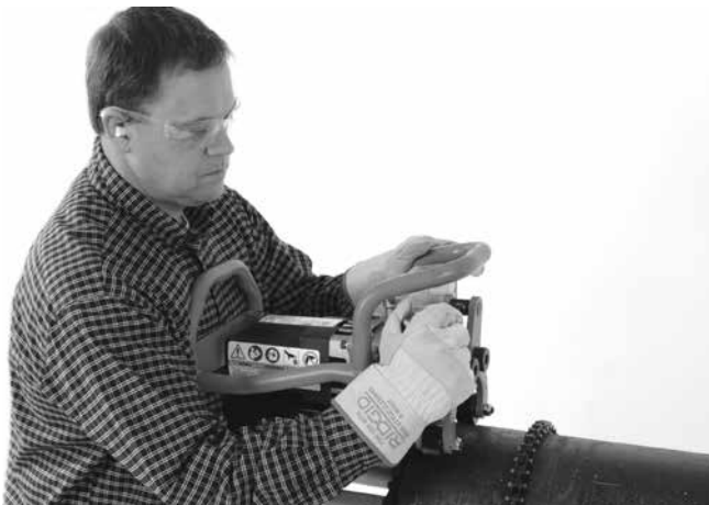
Kuva 17A – Kiristä kiristysruuvi käsin
