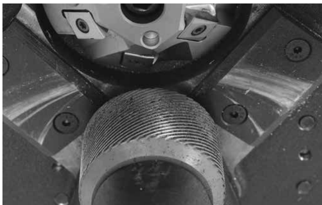
Figur 22 – Rengøring af drivrulleriflanger
