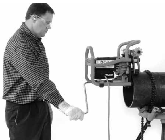
Rys. 19 – Właściwa postawa robocza
