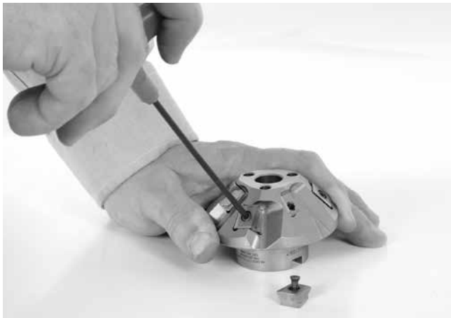
Figura 24 – Substituir Entalhes de Corte
