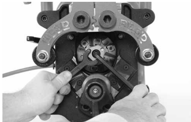
25A-сурет – Кескіштің бас тиектерін өзгерту
