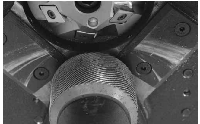
Şekil 22– Tahrik Silindiri Dişlisini Temizleme
