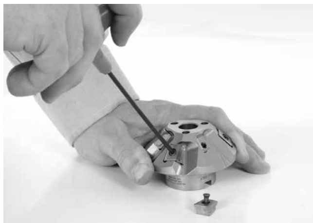
Рис. 24 – Замена вставных резцов
