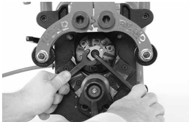
Figur 25A – Vända skärhuvuden
