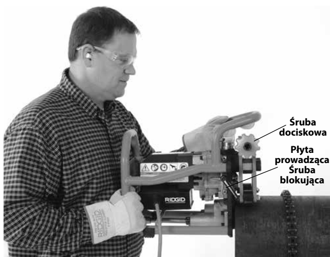
Rys. 15A – Ustawienie ukosowarki na rurze
