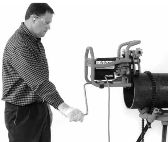
Slika 19 – Pravilan radni položaj
