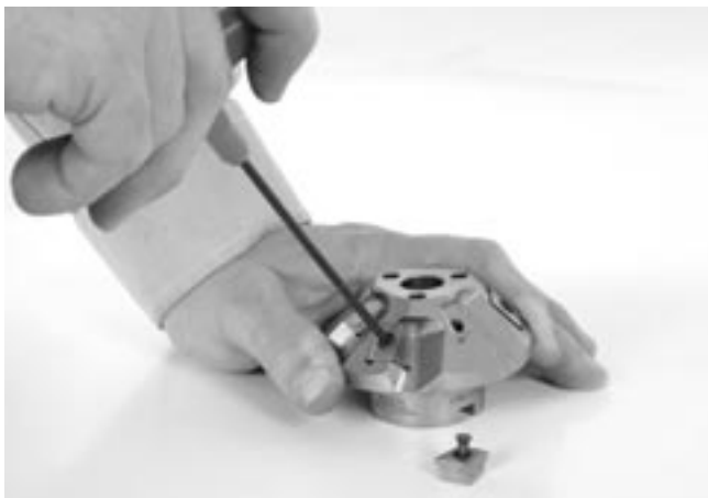
Figure 24 – Remplacement des couteaux
