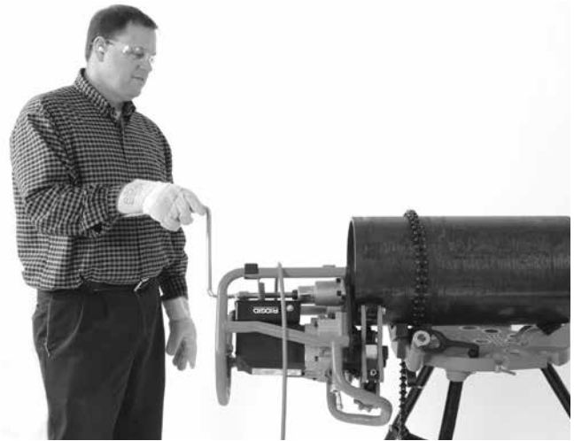
Kuva 20B – Viistäminen (kiinteä työkappale/liikkuva viisteleikkuri)
