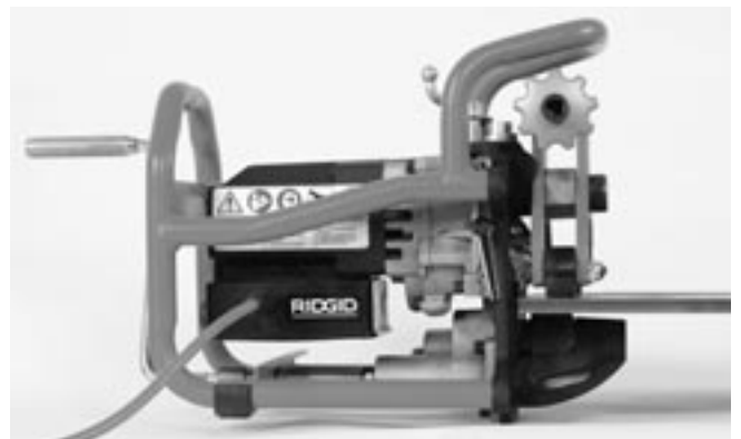
Figure 16B – Montage de la machine à biseauter sur tôle
