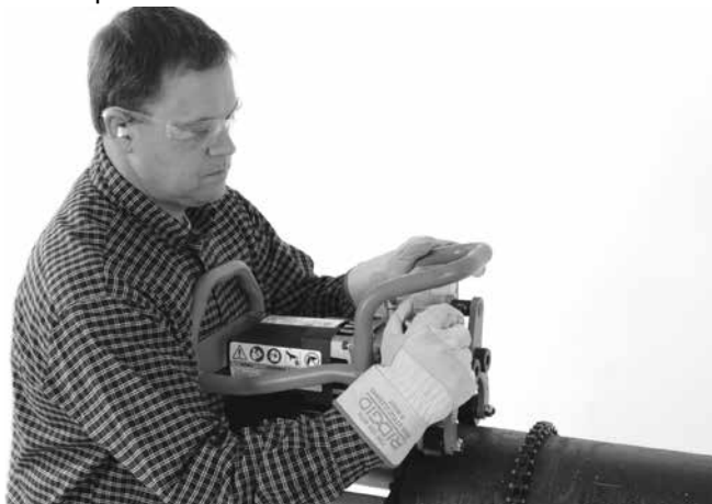
Obrázek 17A – Ručně dotáhněte upínací šroub
