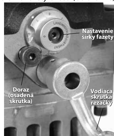
Obrázok 18 – Nastavenie nastavovacej šablóny pre šírku fazety
