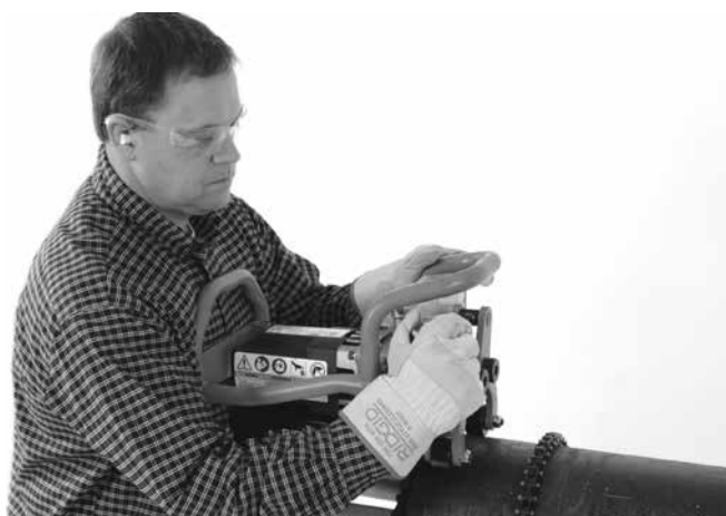
Rys. 17A – Ręczne dokręcanie śruby zaciskowej
