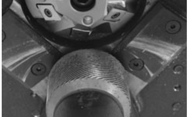
Figure 22 – Nettoyage du moletage du galet d'entraînement
