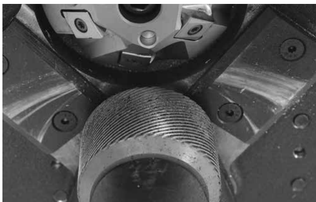
Рис. 22 – Чистые насечки ведущего ролика
