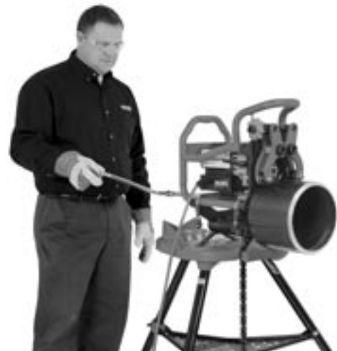
Figura 20C – Operación de biselado (biseladora fija/tubo en rotación)
