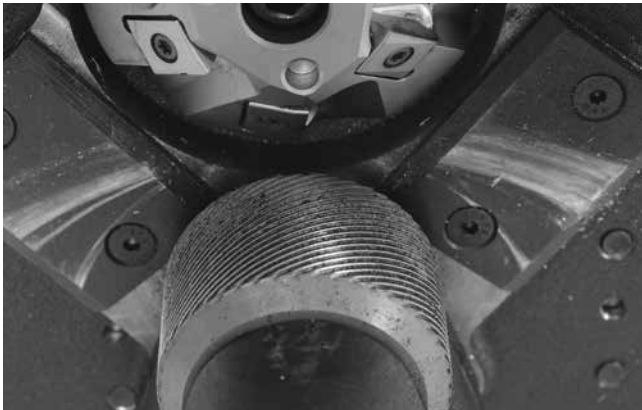
Figuur 22 – Reinig het groefoppervlak van de aandrijfrol
