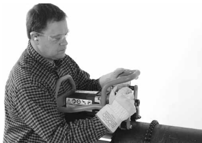
Figura 17A – Aperto Manual do Parafuso de Aperto
