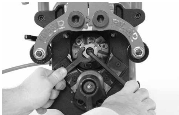
Kuva 25A – Leikkuupäiden vaihto
