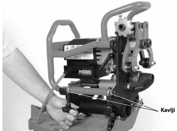
Slika 9 – Pritrjevanje posnemovalca robov na adapter
