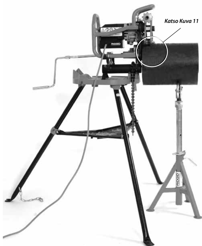
Kuva 12 – Kiinteä viisteleikkuri, lyhyt putki, yksi putkituki
