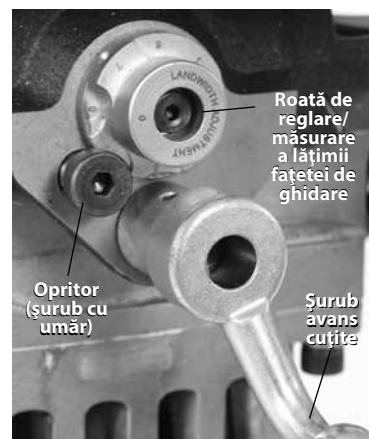
Figura 18 – Setarea roții de reglare/măsurare a lățimii fațetei de ghidare
