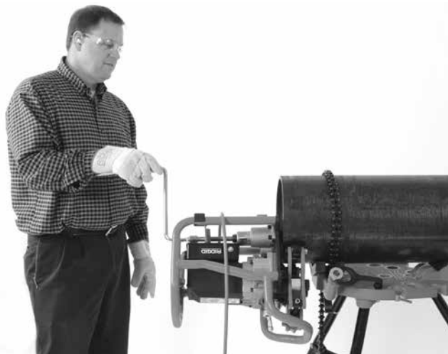
Figur 20B – Affasningsproces (fast arbejdsemne/ bevægeligt affasningsværktøj)
