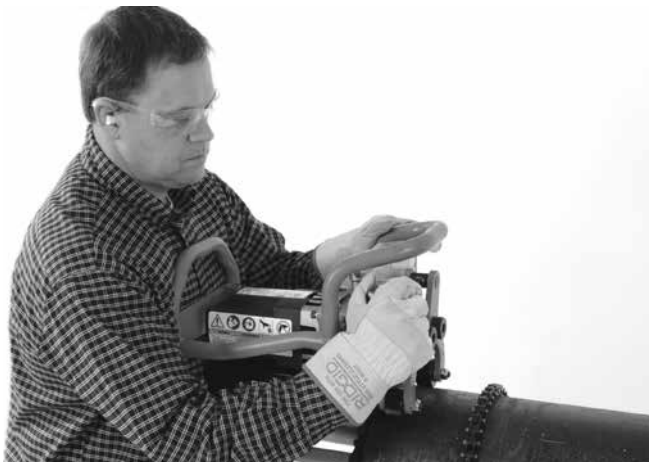
Εικόνα 17Α – Σφίξτε τη βίδα σύσφιξης με το χέρι
