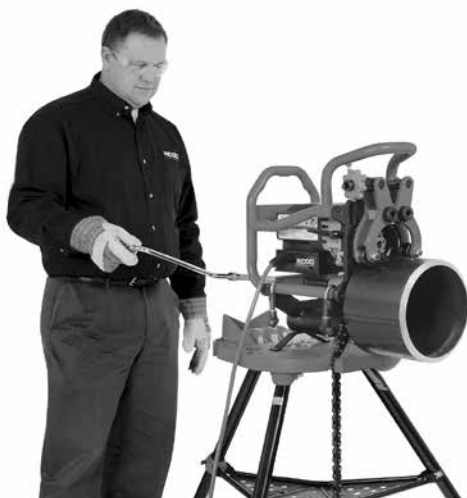
20C ábra – Leélezési művelet (Fix leélezőgép/Forgó cső)
