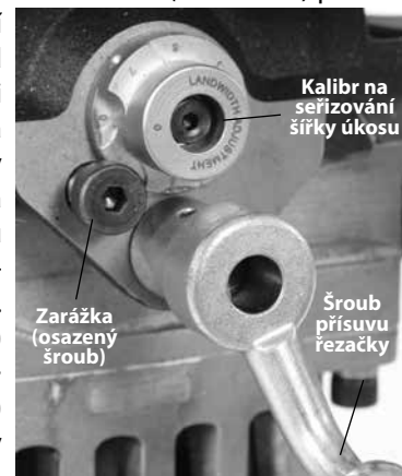
Obrázek 18 – Nastavení kalibru na seřizování šířky úkosu
