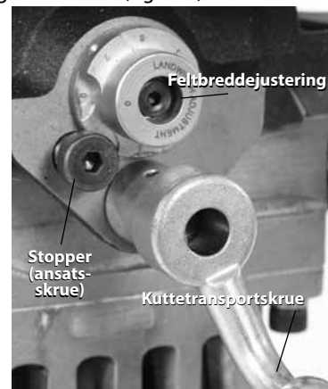
Figur 18 – Innstilling av feltbreddejusteringsmåler
