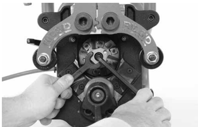
Figur 25A – Skift af skærehoveder
