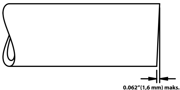
Slika 5 – Zahtjevi za rezanje cijevi pod pravim kutom
