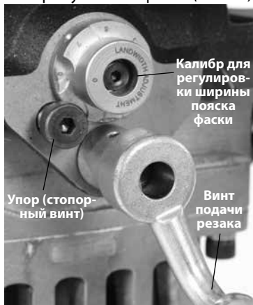
Рис. 18 – Установка калибра для регулировки ширины пояска фаски
