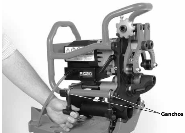
Figura 9 – Fixar o Biselador ao Adaptador
