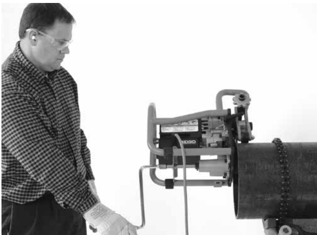
Figur 20A – Utfasing (Fast arbeidsemne / Bevegelig fasemaskin)
