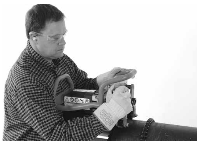
17A ábra – A befogócsavar megszorítása kézzel
