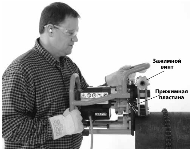
Рис. 15А – Установка станка для снятия фаски на трубу
