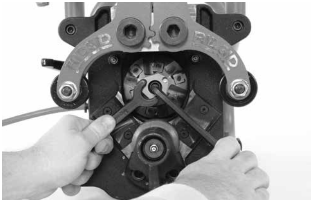
Εικόνα 25A – Αλλαγή κοπτικών κεφαλών
