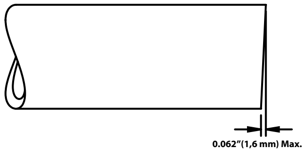
Figur 5 – Krav på rörets vinkelräthet
