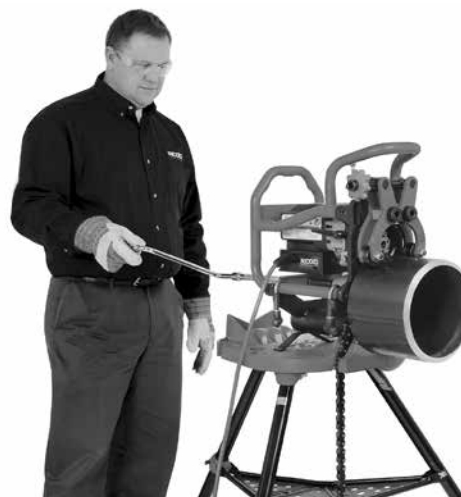
Εικόνα 20C – Λειτουργία φρεζαρίσματος (Σταθερό εργαλείο φρεζαρίσματος σωλήνων/περιστρεφόμενος σωλήνας)
