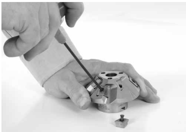
Slika 24 – Zamenjava rezalnih vstavkov
