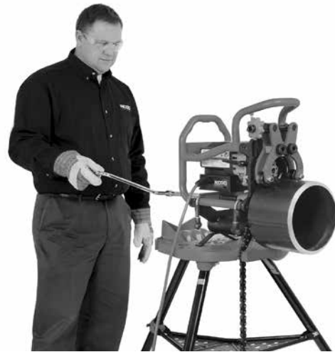
Kuva 20C – Viistäminen (kiinteä viisteleikkuri/pyöritä putki)
