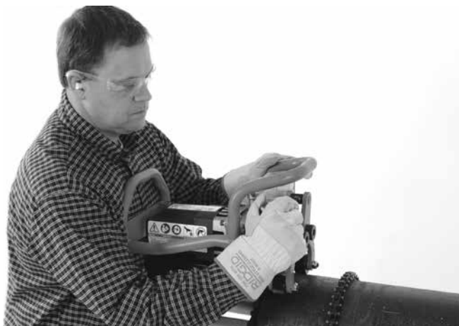
Рис. 17А – Затягивание зажимного винта от руки
