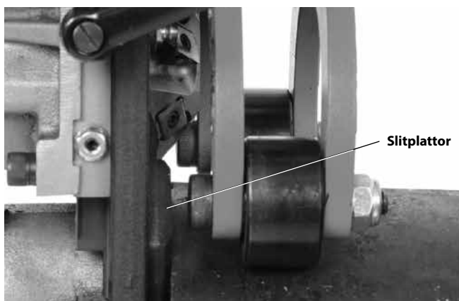
Figur 15B – Slitplatta i linje med rörets ände
