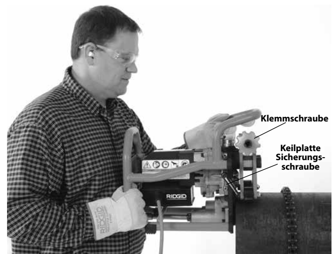
Abbildung 15A – Platzieren des Anfasgeräts am Rohr
