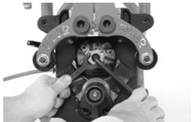
Figura 25A – Cambio del cabezal cortador
