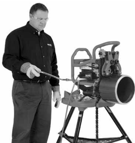
Obrázok 20C – Úkosovanie (uchytená úkosovačka / rotujúca rúrka)
