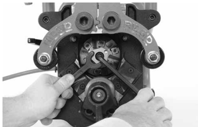
Rys. 25A – Zmiana głowic tnących
