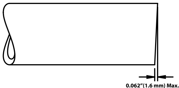
Figura 5 – Cerințe de perpendicularitate a țevii
