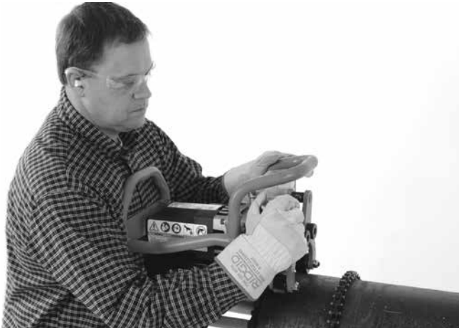
Şekil 17A – Sıkıştırma Vidasını Elle Sıkın
