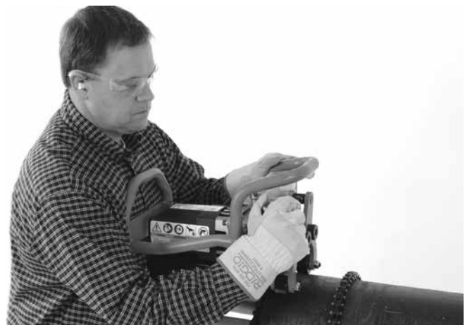
Figuur 17A – Klemmschroef met de hand vastdraaien
