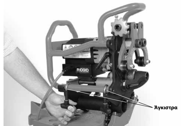
Εικόνα 9 – Τοποθέτηση του εργαλείου φρεζαρίσματος στον προσαρμογέα
