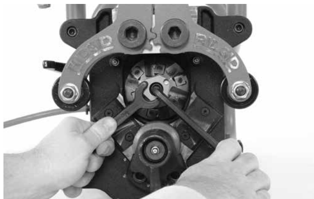
Slika 25A – Menjanje rezne glave
