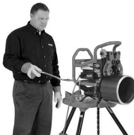
Rys. 20C – Czynność ukosowania (nieruchoma ukosowarka/obracająca się rura)
