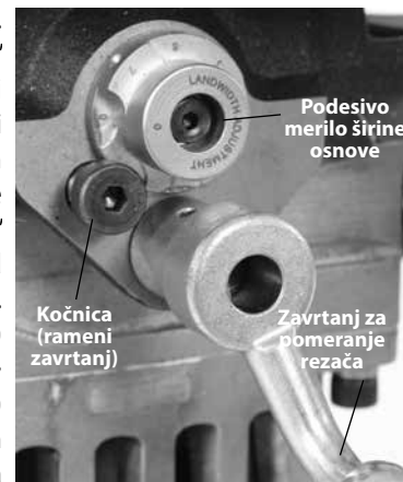
Slika 18 – Podešavanje podesivog merila širine osnove
