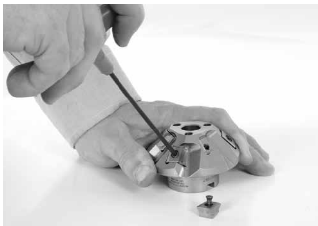
Figur 24 – Udskiftning af skæreindsatser
