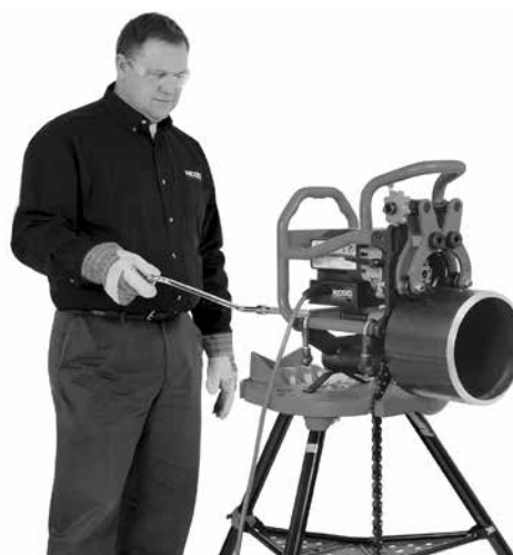
Obrázek 20C – Postup úkosování (fixní úkosovačka/otáčející se trubka)
