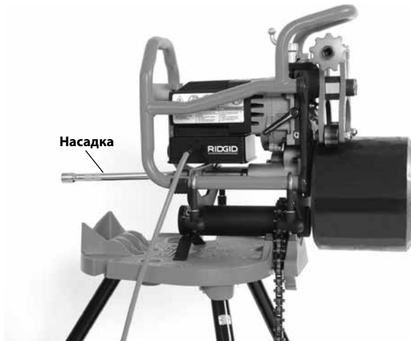
Рис. 10 – Закрепленный станок для снятия фаски, длина трубы меньше 12" и вес меньше 50 фунтов
