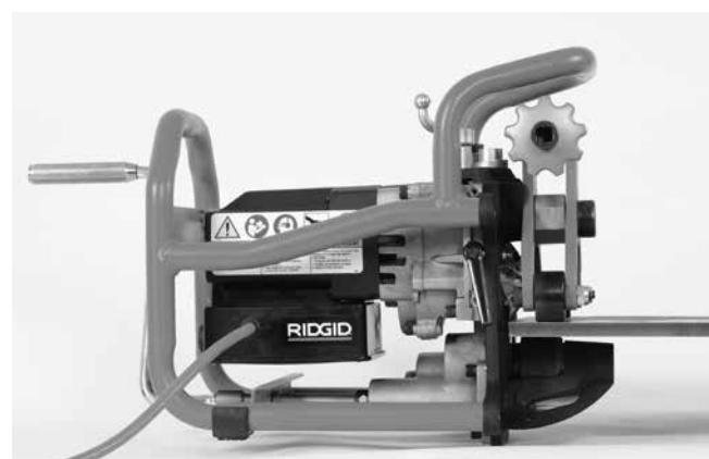
Figura 16B – Installazione della Smussatrice sul Tubo
