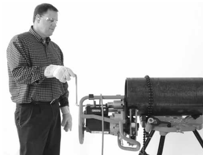
Figura 20B – Operația de șanfrenare (Piesă de prelucrat fixă / Mașină de șanfrenare mobilă)
