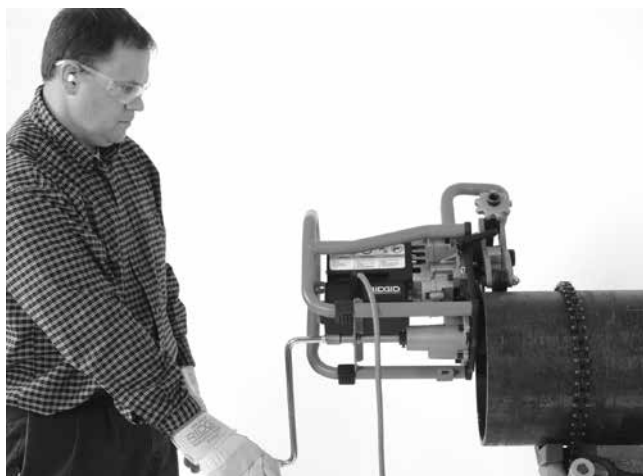
20А-сурет – Қиғаш кесу әрекеті (Тұрақты жұмыс нысаны/Қиғаш кесу құралын жылжиты)
