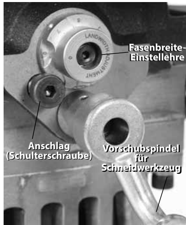
Abbildung 18 – Einstellung der Fasenbreite-Einstellehre
