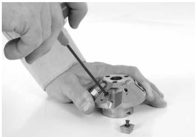
Obrázok 24 – Výmena rezných vložiek
