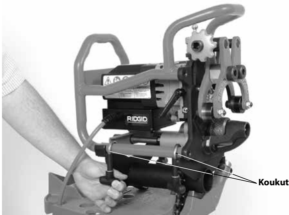
Kuva 9 – Viisteleikkurin kiinnitys adapteriin
