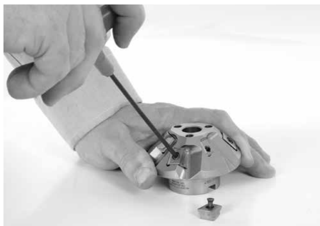
Obrázek 24 – Výměna řezacích vložek
