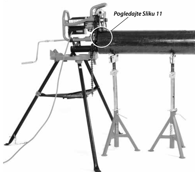
Slika 13 – Fiksiran alat za obaranje ivica, duga cev, višestruka postolja cevi
