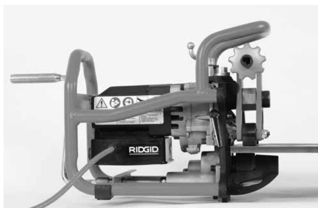
Obrázek 16B – Umístění úkosovačky na plech
