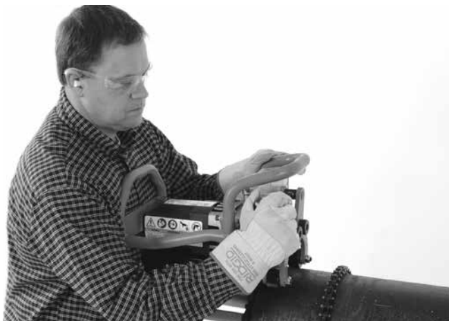
Figura 17A – Stringere a mano il Morsetto a vite
