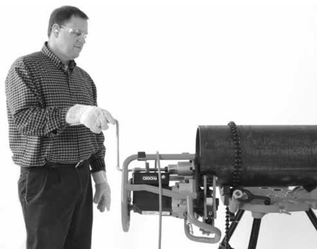
Obrázek 20B – Postup úkosování (fixní opracovávaný kus/pohyblivá úkosovačka)
