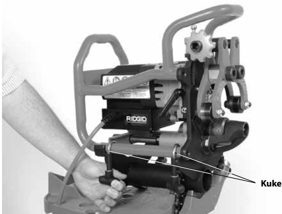
Slika 9 – Učvršćivanje alata na prilagodnik
