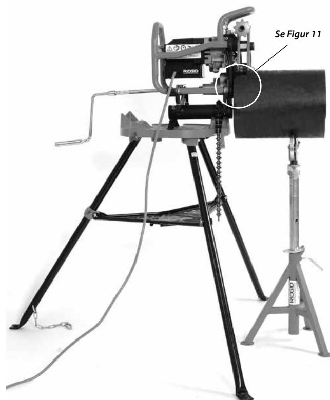
Figur 12 – Fast affasningsværktøj, kort rør, en rørstøtte
