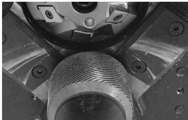
Rys. 22 – Czyszczenie radełek rolki posuwu
