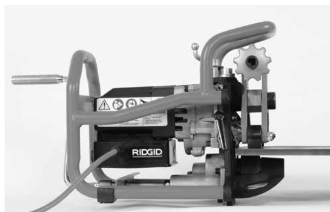
Figuur 16B – Afschuinapparaat aanbrengen op plaat
