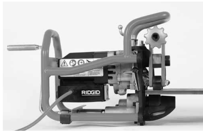
Abbildung 16B – Anbringen des Anfasgeräts an einer Platte
