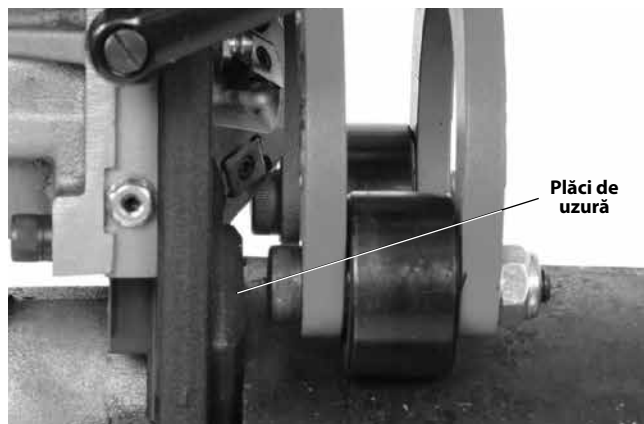
Figura 15B – Placă de uzură la nivel cu capătul țevii
