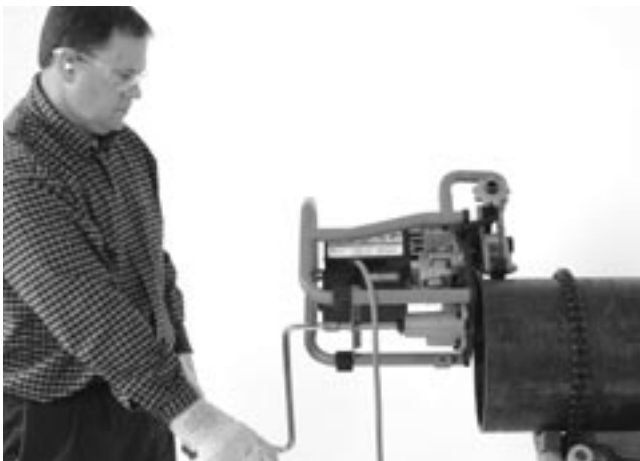
Figura 20A – Operación de biselado (pieza fija/biseladora móvil)
