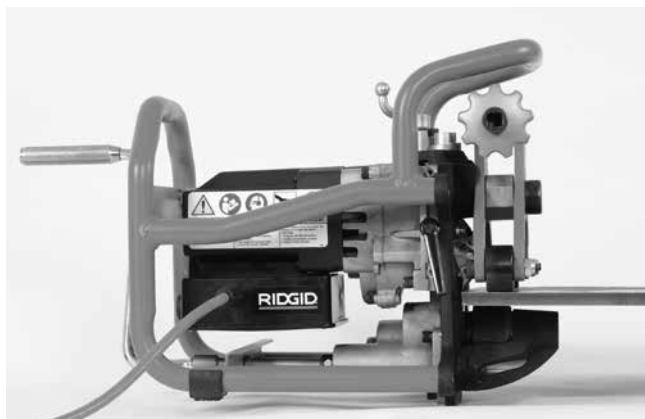
Εικόνα 16B – Εγκατάσταση του εργαλείου φρεζαρίσματος πάνω σε πλάκα
