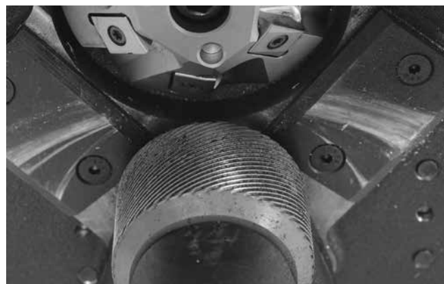
Obrázek 22 – Vyčistěte rýhování hnacího válce
