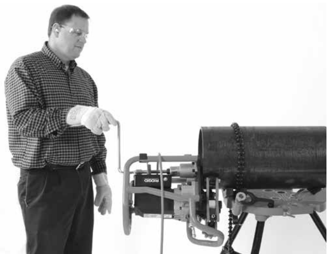
Figur 20B – fasing (Fast arbeidsemne / Bevegelig fasemaskin)
