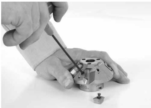
Slika 24 – Zamjena reznih umetaka
