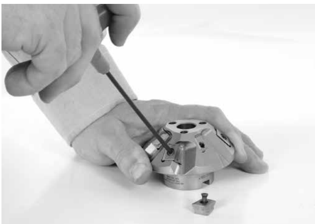
Figuur 18 – Snijkopinzetstukken vervangen
