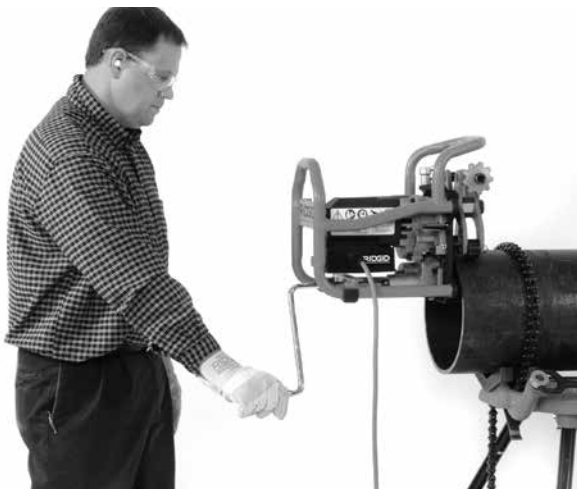
Figura 19 – Poziția corectă de operare
