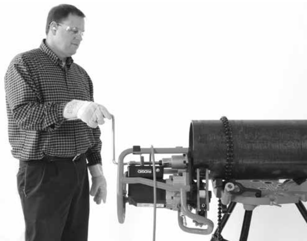
Εικόνα 20B – Λειτουργία φρεζαρίσματος (Σταθερό τεμάχιο εργασίας/κινούμενο εργαλείο φρεζαρίσματος σωλήνων)
