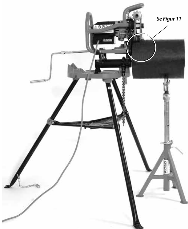
Figur 12 – Fast fasemaskin, kort rør, ett rørstativ
