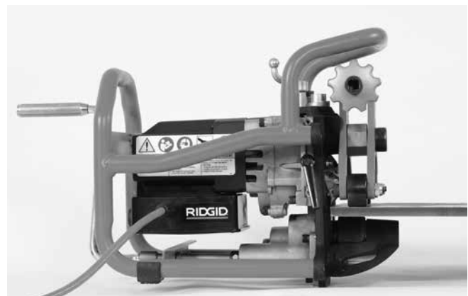
Рис. 16В – Установка станка для снятия фаски на лист
