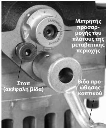
Εικόνα 18 – Ρύθμιση του μετρητή προσαρμογής του πλάτους μεταβατικής περιοχής
