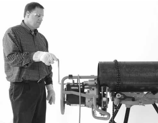
Slika 20B – Obrada ruba cijevi (Fiksirani radni dio/ pomični alat)
