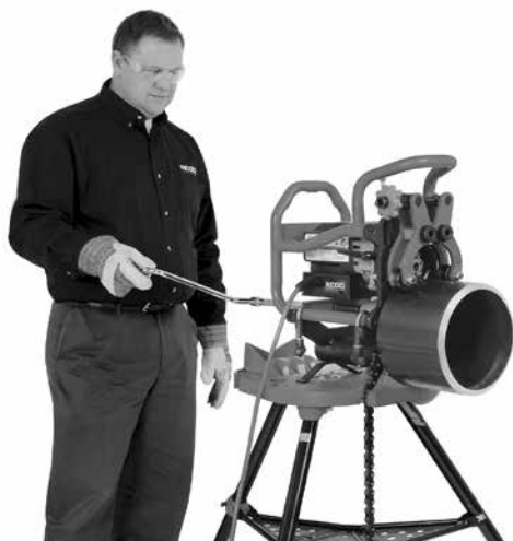
Figuur 20C – Afschuinen (Vastgezet afschuinapparaat/Roterende pijp)
