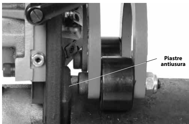
Figura 15B – Piastra antiusura a filo con l'Estremità del tubo
