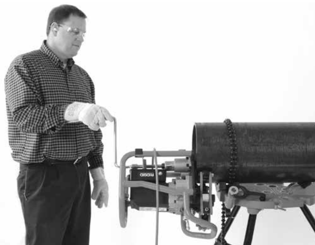
Figuur 20B – Afschuinen (Vastgezet werkstuk/Bewegend afschuinapparaat)
