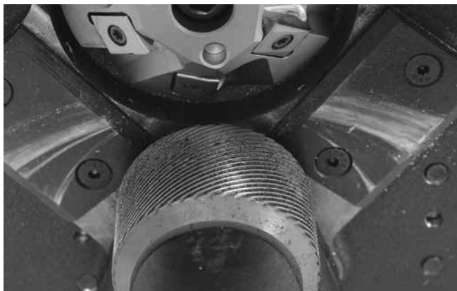
Figura 22 – Limpar Rolos de Estriagem
