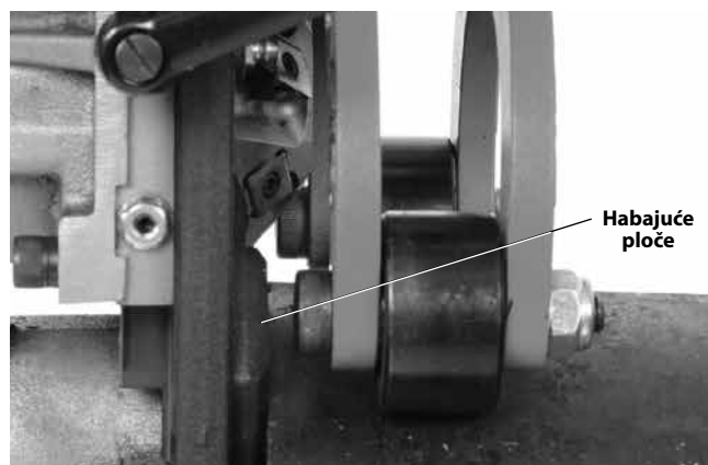
Slika 15B – Habajuća ploča dolazi do ivice cevi
