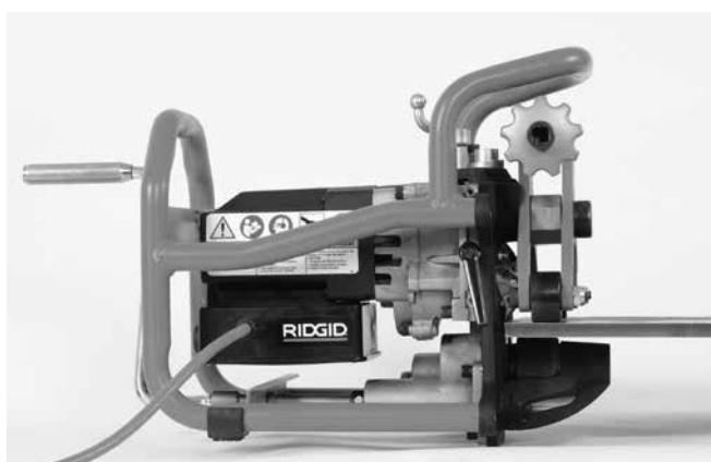
Obrázok 16B – Inštalácia úkosovačky na plechu
