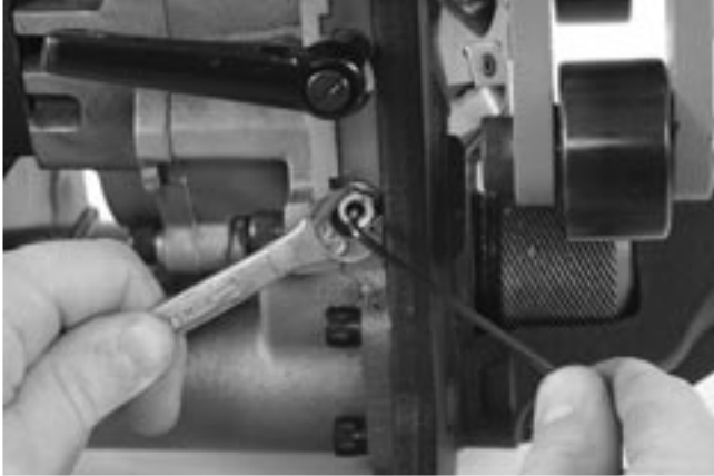
Figura 27 – Ajuste de la placa de deslizamiento
