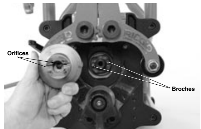
Figure 25B – Remplacement des têtes de coupe
