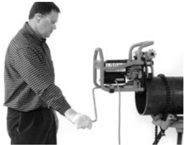
Figure 19 – Position de travail appropriée
