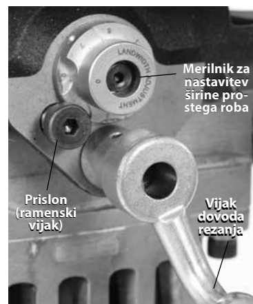
Slika 18 – Nastavitev merila širine prostega roba
