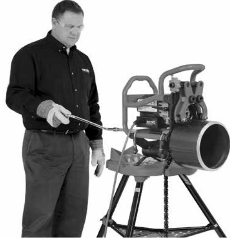
Şekil 20C – Pahlama İşlemi (Sabit Pahlama Makinesi/ Dönen Boru)
