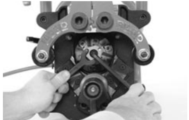
Figure 25A – Changement des têtes de coupe
