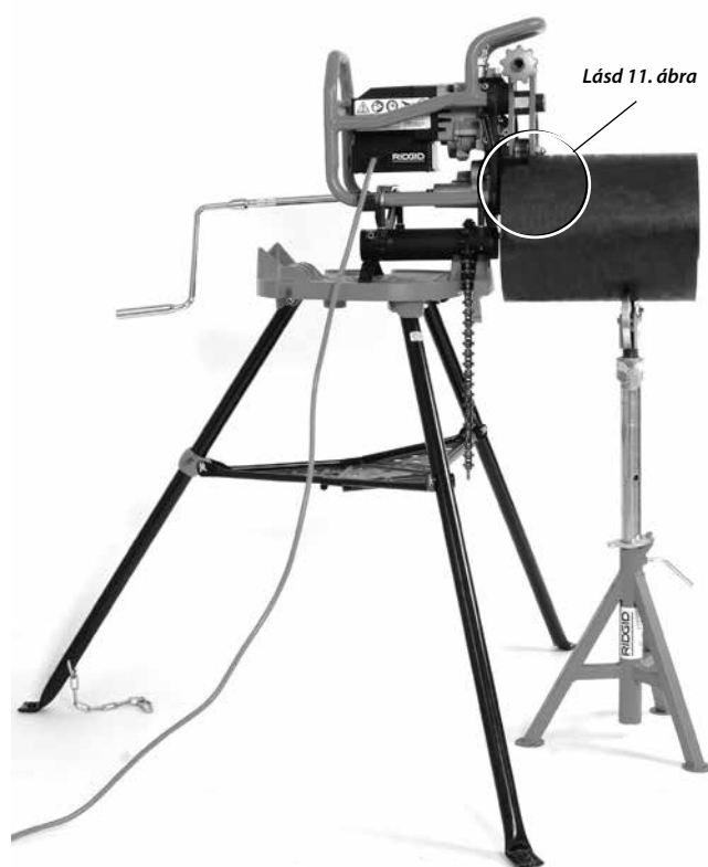
12. ábra – Fix leélező gép, Rövid cső, Egy csőállvány
