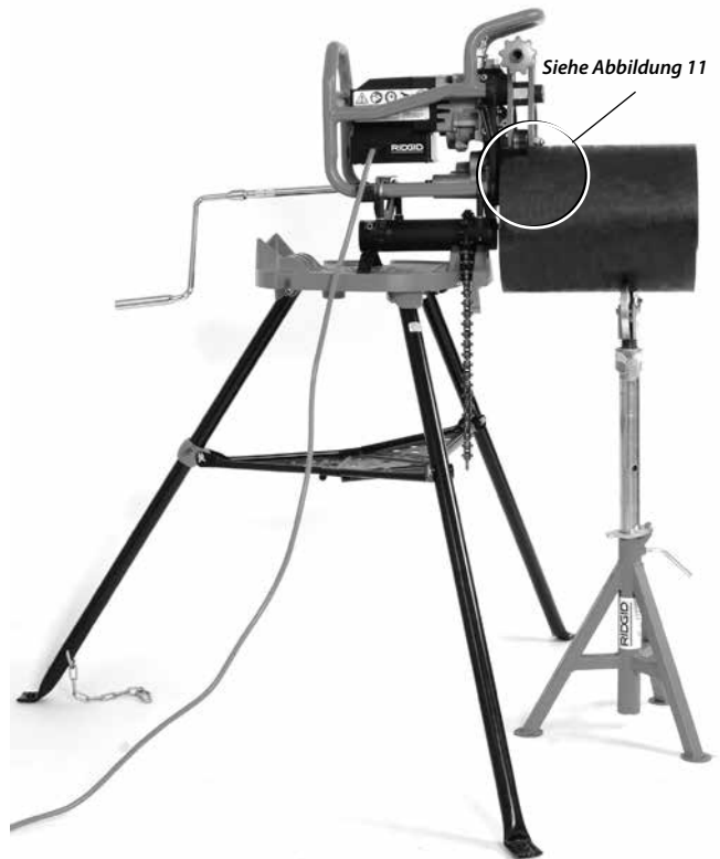
Abbildung 12 – Fixiertes Anfasgerät, kurzes Rohr, ein Rohrstände
