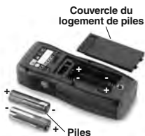
Figure 5 – Remplacement des piles
