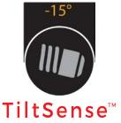
Ce capteur de données affiche l'inclinaison de la caméra à l'intérieur de la conduite.
