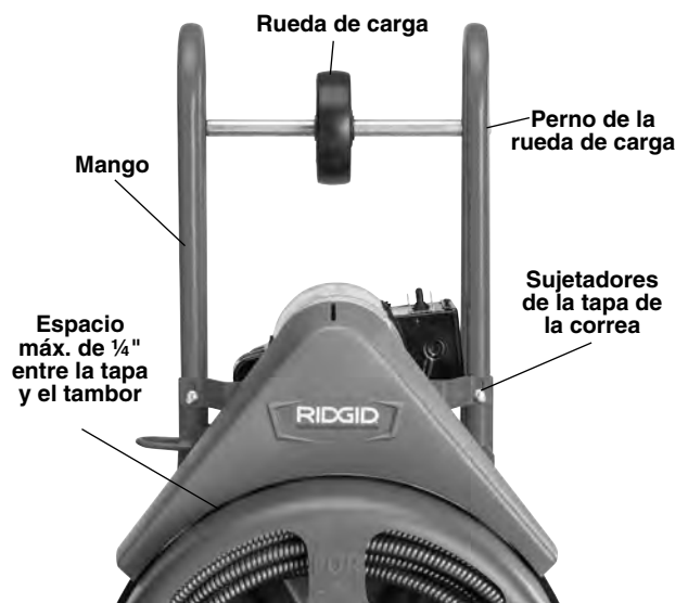
Figura 3 – Instalación de los mangos y ajuste de la tapa de la correa
