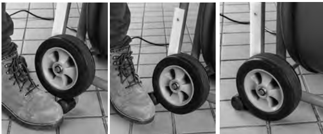
Figura 8 – Montaje de las patas de soporte
