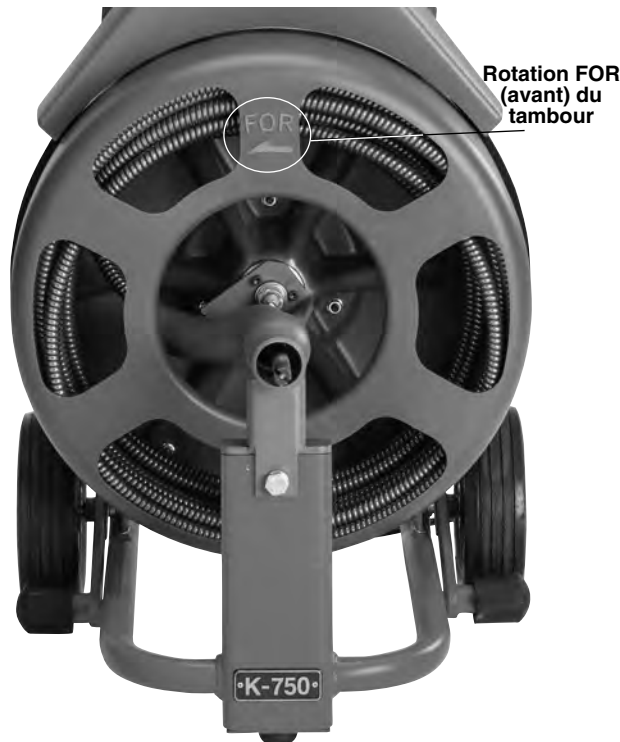
Figure 6 – Sens de rotation appropriée en position 'FOR' (avant)
