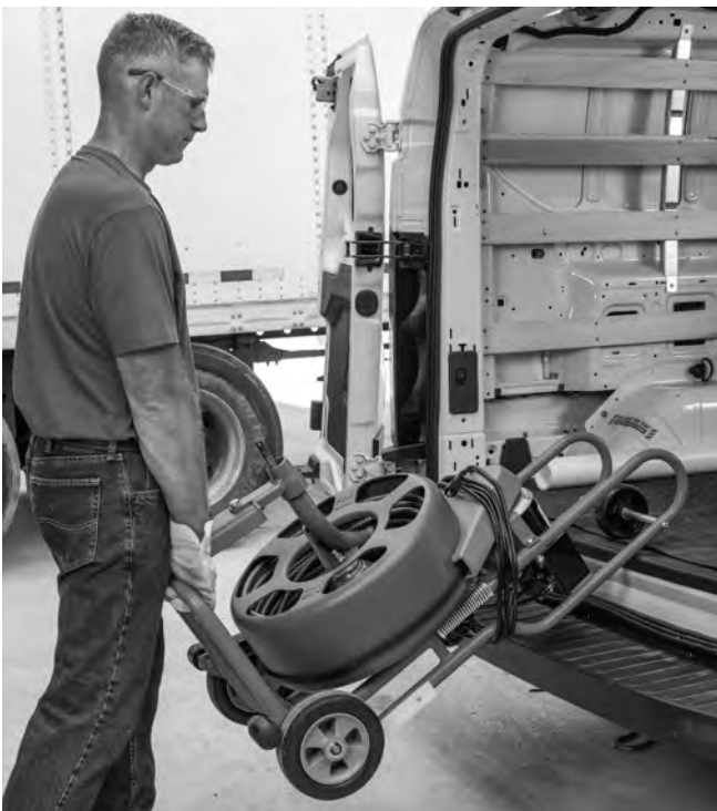
Figura 15 – Colocación de la máquina en el camión
