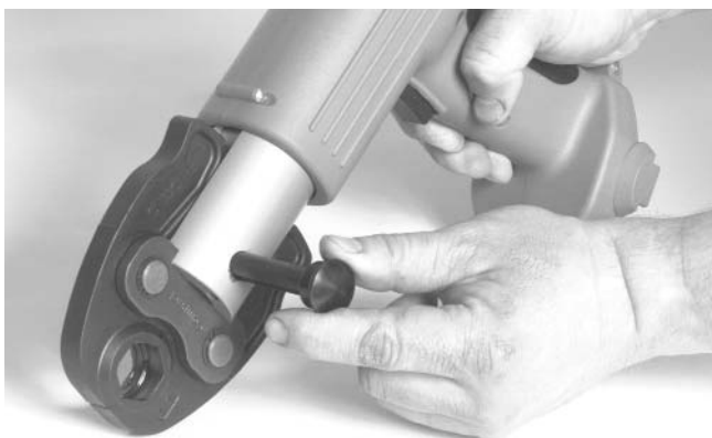
Figure 2 – Retrait de la broche de fixation des mâchoires
