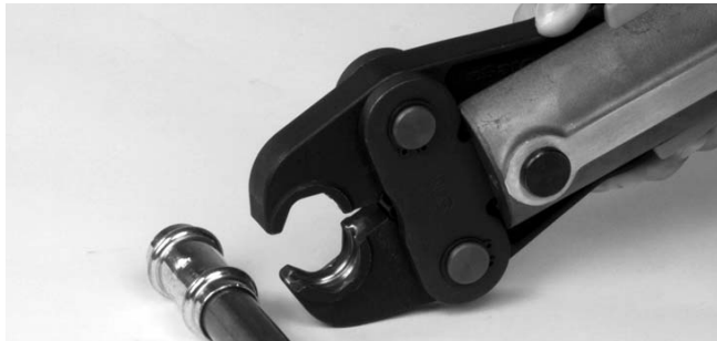
Figura 5 – Apertura de las mordazas tipo tijeras
