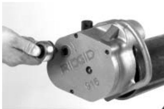
図 8 ラチェットの駆動部への取付け
