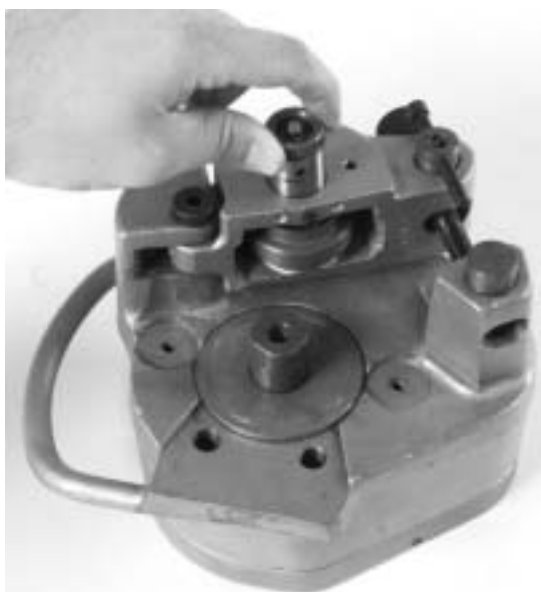
図 12 グループロールシャフトの取付け
