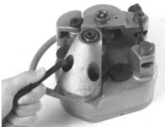
図 13 サポートハウジングの取付け
