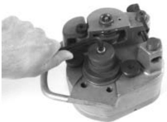
図9 ドライブシャフトのボルトを外す
