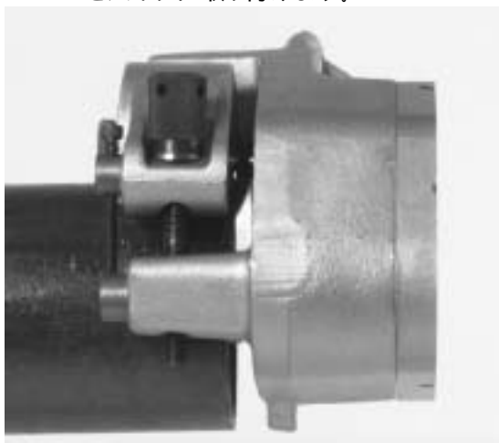
図 4 グルーバーをパイプに取付ける
