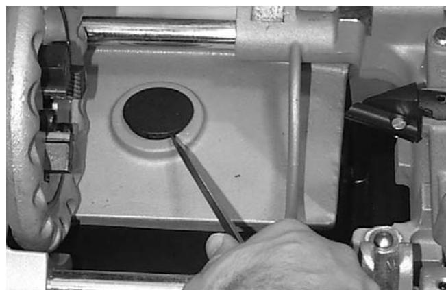
Figura 18 - Extracción del tapón en la carcasa
