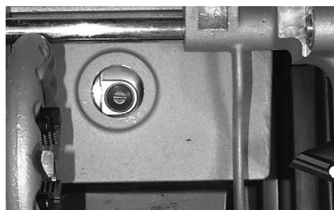
Figura 19 - Se ha extraído el tapón de la tapa de las escobillas en la carcasa y el sujetador de la escobilla ha quedado al descubierto
