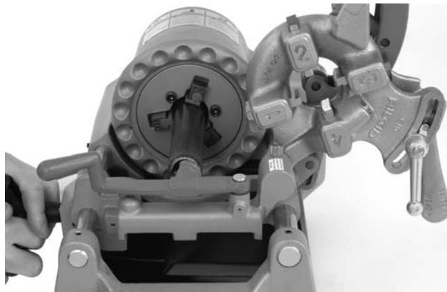
Figura 12 - Escariado de un tubo con la Escariadora No. 334
