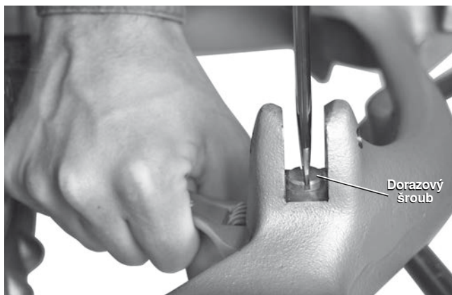
Obrázek 13 – Nastavení dorazového šroubu
