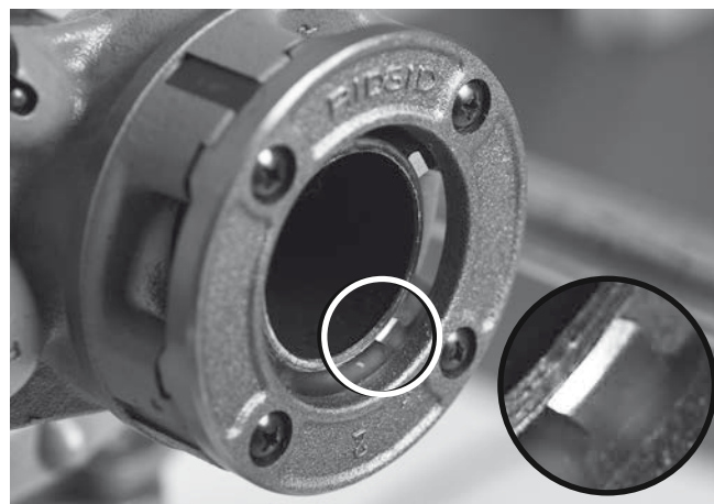
Slika 19 – Cev poravnata sa ivicom nareznice
