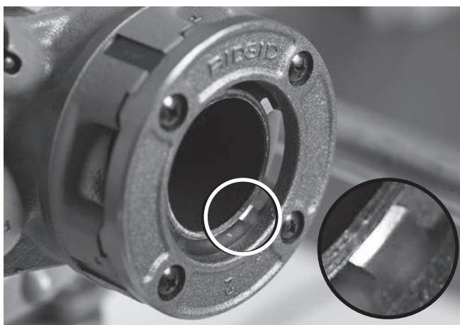
Figure 19 – Tuyau à fleur de l'extrémité des filières
