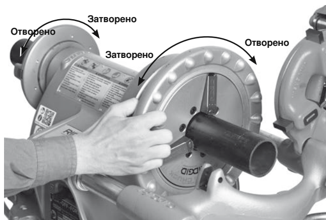
Фигура 14 – Захващане на тръба в патронника
