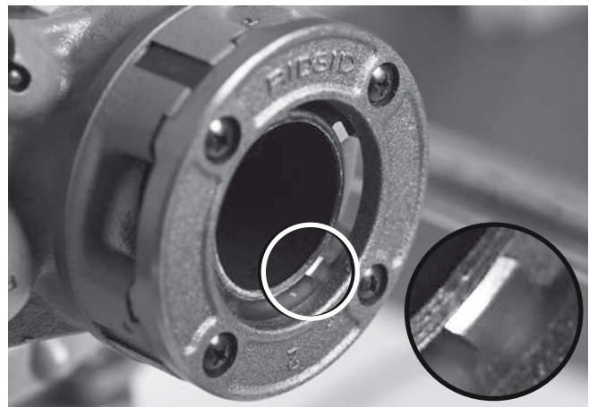
Kuva 19 – Putki terien reunan tasalla
