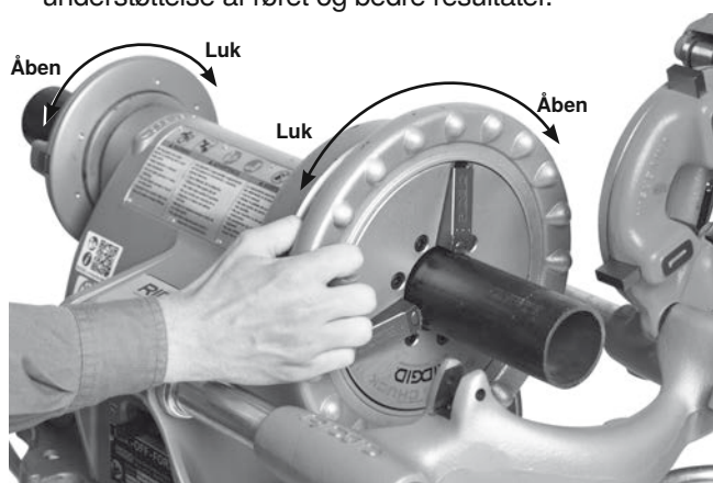
Figur 14 – Fastgørelse af rør
