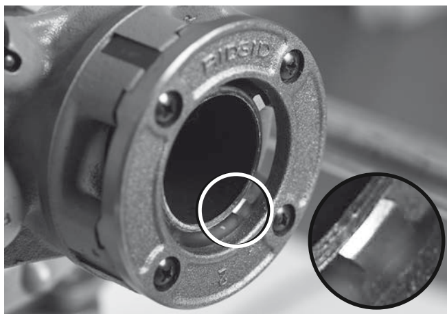
Figura 19 – Tubo alinhado com extremidade das tarraxas
