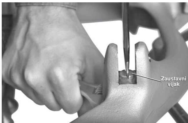
Slika 13. – Podešavanje zaustavnog vijka
