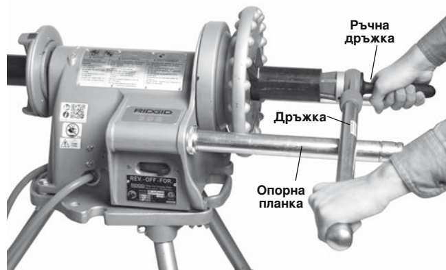
Фигура 16 - Разкрояване на тръби с ръчен разкрояващ инструмент, (дръжката на разкрояващия инструмент да е в контакт с опорната греда)
