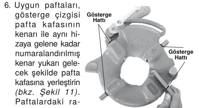
Şekil 11 – Paftaların Takılması
