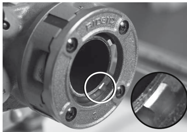
Рис. 19 — Торец трубы вровень с кромкой резьбонарезных гребенок
