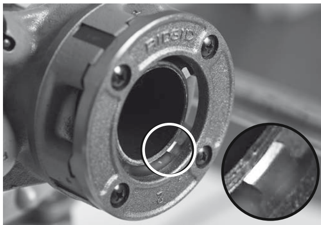
19. ábra – A cső a menetvágók szélével egy síkban van
