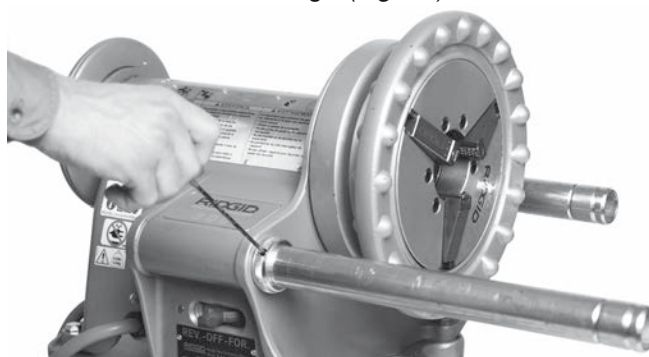
Figur 8 – Placering af stilleskrue
