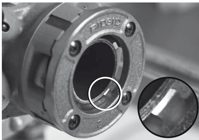
Abbildung 19 – Rohr fluchtet mit Kante der Schneidbacken
