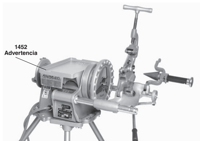
Figura 7 B – Instalación del carro 311 y herramientas
