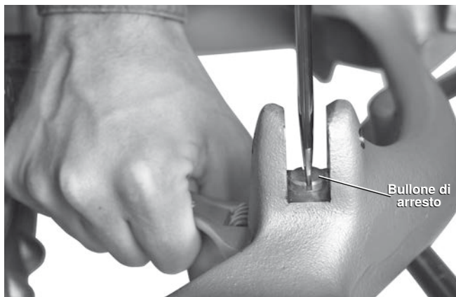
Figura 13 – Regolazione bullone di arresto
