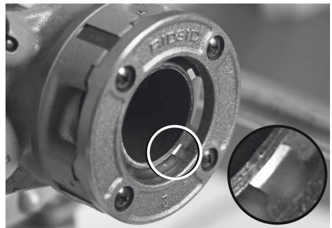
Εικόνα 19 - Σωλήνας στο ίδιο επίπεδο με το άκρο των μαχαιριών
