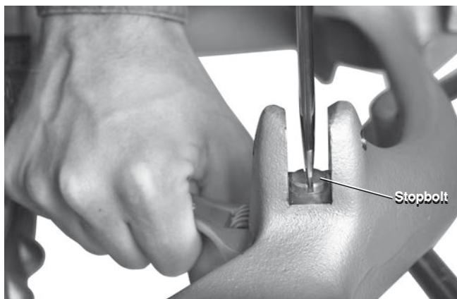
Figur 13 – Justering af stopbolt
