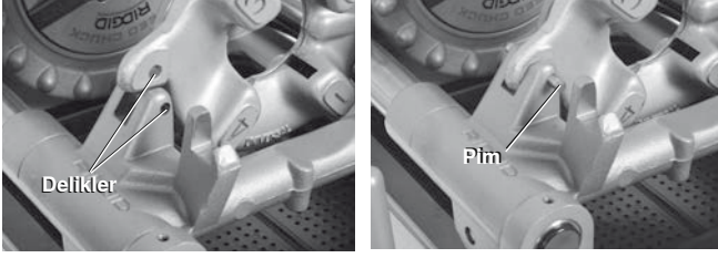
Şekil 24 – Sol Pafta Kafasının Yerinde Tutulması
