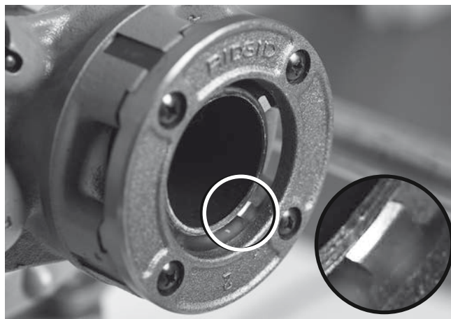
19-сурет – Кескіштер жиегімен бір деңгейдегі құбыр
