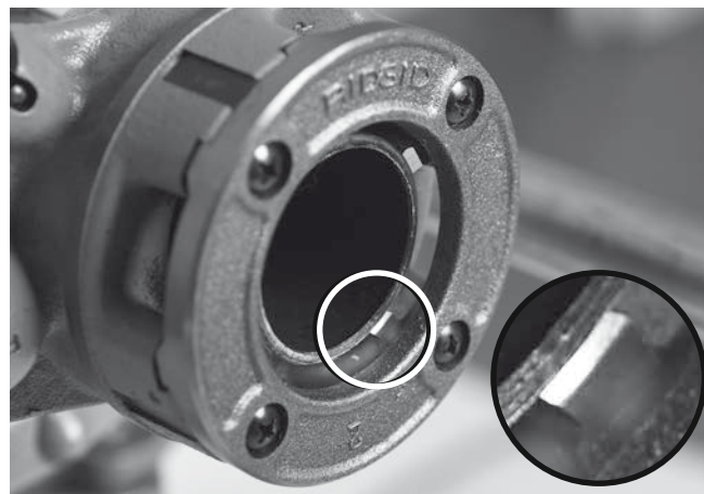
Figura 19 – Țeava la nivel cu marginea filierelor
