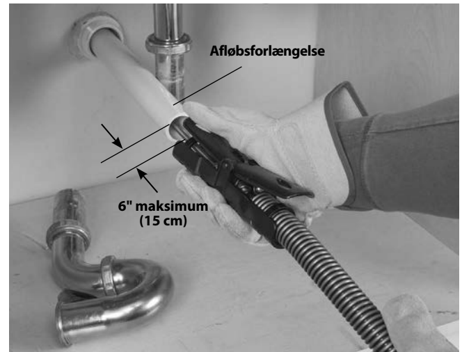
Figur 7 – Eksempel på forlængelse af afløbet til inden for en afstand af 6" (15 cm) fra AUTOFEED-enheden.
