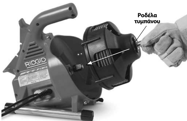
Εικόνα 16 – Τοποθέτηση του τύμπανου στο μηχάνημα
