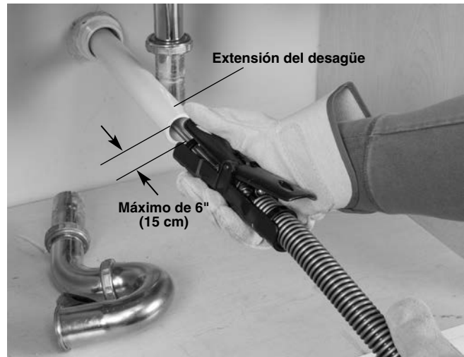
Figura 7 – Ejemplo de cómo extender el desagüe para que el acceso quede a menos de 6 pulgadas (15 cm) del alimentador AUTOFEED.
