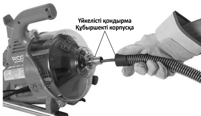
4-сурет – Кабельді бағыттауыш құбыршекке өткізу
