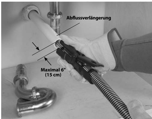
Abbildung 7 – Beispiel für eine Verlängerung des Ablaufs auf weniger als 6" (15 cm) von der AUTOFEED-Einheit
