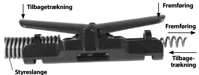
Figur 9 – Greb til fremføring/tilbage-trækning
