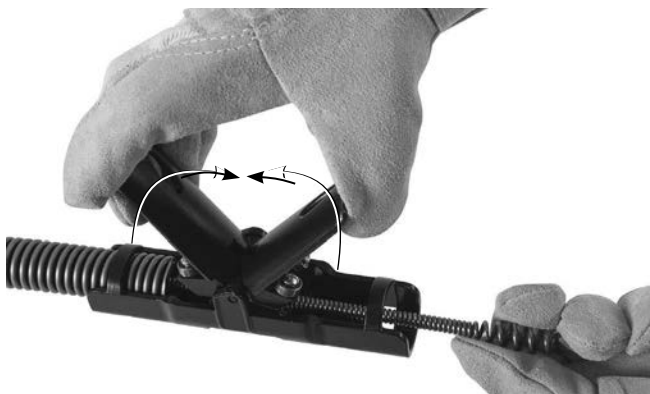
Figur 5 – Før kabelen gjennom AUTOFEED®-enheten
