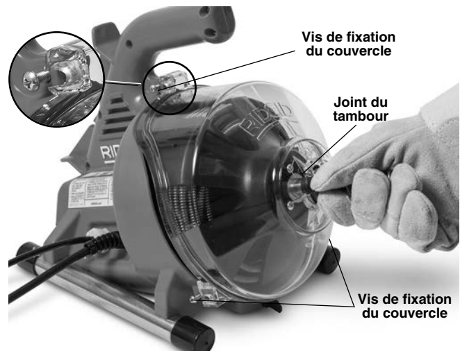
Figure 13 – Ouverture du dégorgeoir
