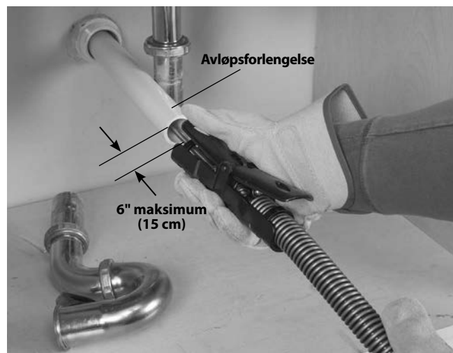
Figur 7 – Eksempel på utvidelse av sluket så det er innenfor 6" (15 cm) for AUTOFEED-enheten.
