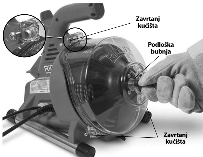
Slika 13 – Otvaranje čistača odvoda
