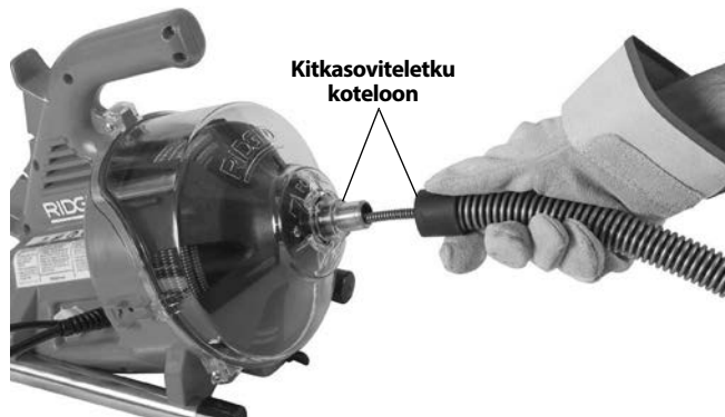
Kuva 4 – Jousen syöttäminen suojaletkun läpi
