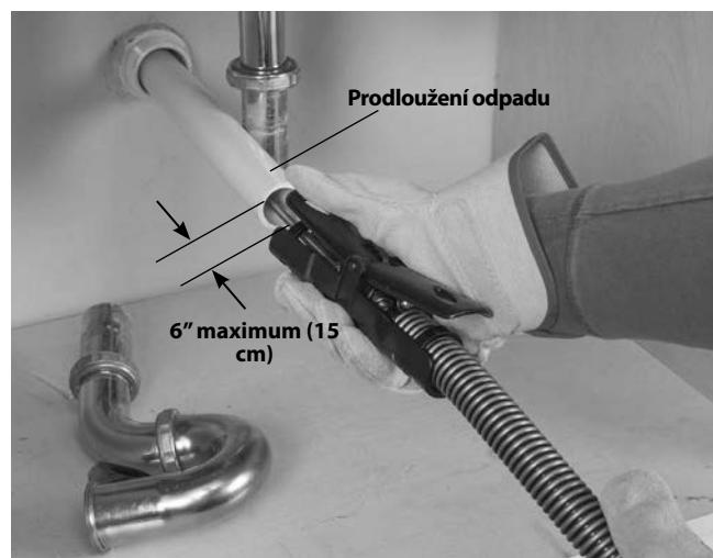
Obrázek 7 – Příklad prodloužení odpadu na vzdálenost do 6" (15 cm) od jednotky AUTOFEED.
