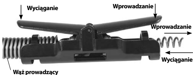
Rysunek 9 – Dźwignia posuwu postępowego/cofającego
