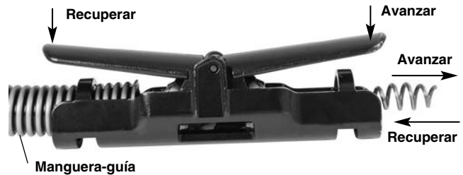
Figura 9 – Palancas para avanzar o recuperar el cable
