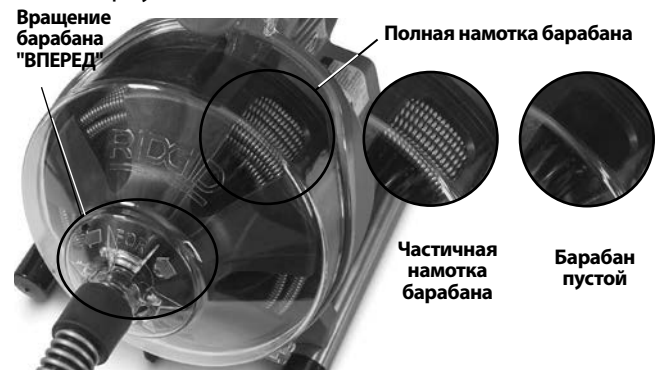
Рис. 10 – Контроль троса в барабане
