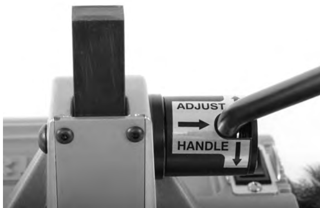
Figura 8 – Cómo ajustar la posición de la manivela
