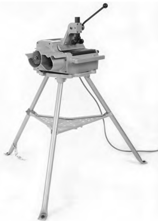
Figura 7 – Máquina modelo 122XL colocada en el soporte 1206
