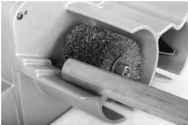
Figura 11 – Limpieza del exterior del tubo
