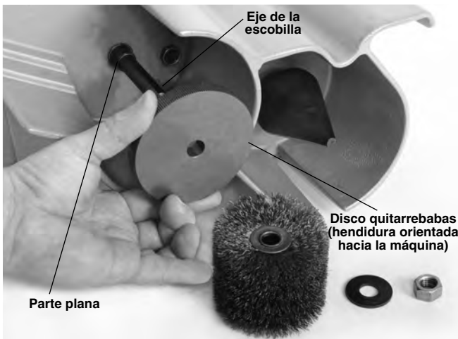
Figura 5 – Montaje del disco quitarrebabas
