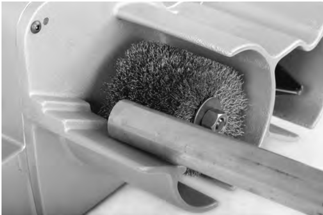
Figure 11 – Nettoyage externe du tube
