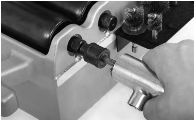
Figura 14 – Limpieza del interior de un acoplamiento
