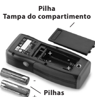
Figura 5 – Substituição das Pilhas
