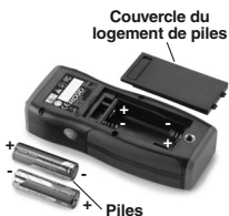
Figure 5 – Remplacement des piles
