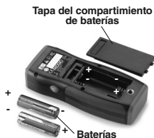
Figura 5 – Reemplazo de las baterías
