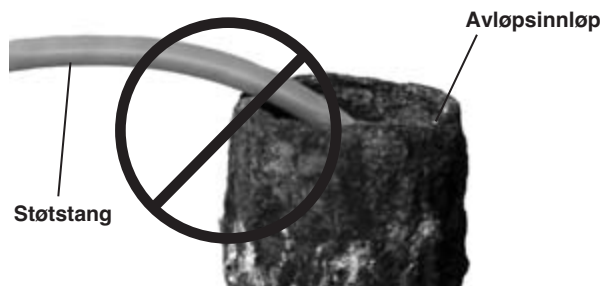
Figur 23 – Unngå å trekke den over skarpe kanter
