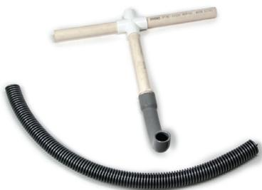
Usando un tubo e una conduttura in PVC si può fabbricare un tubo guida con un tubatura di invito ricurva in fondo, per guidare il Cavo di Spinta oltre la tubatura di porcellana senza danneggiarla.
