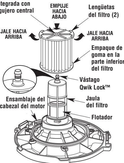
El filtro se debe limpiar a menudo para mantener un rendimiento óptimo de la aspiradora.
