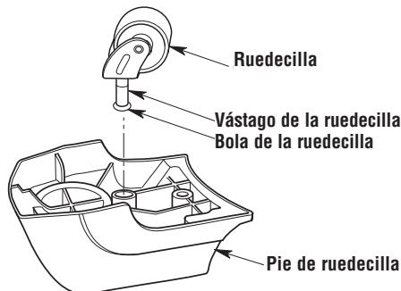
4. Coloque el pie de ruedecilla con ruedecilla sobre el poste ubicado en la parte inferior del tambor para polvo y presíñelo firmemente en la posición correcta, de la manera que se muestra en la ilustración.
