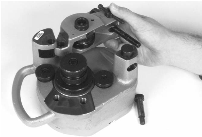
Figure 15 – Retrait de la vis d'avancement
