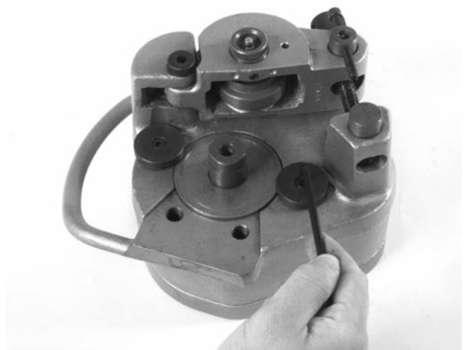
Figure 13 – Installation des stabilisateurs
