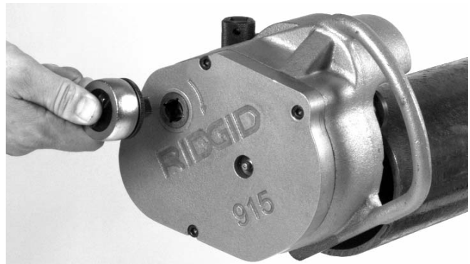
Figura 7 – Trinquete en la entrada de la transmisión
