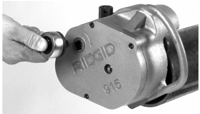
Figure 7 – Clé à cliquet introduite dans le carter de rotation.
