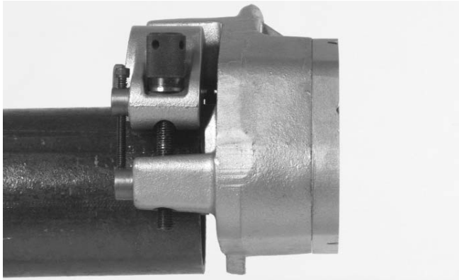
Figura 3 – Montaje de la Ranuradora sobre el tubo
