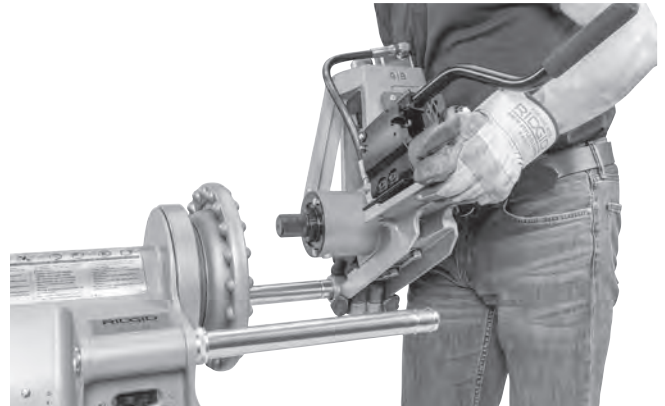
Abbildung 7A - Installation des 918 am 300 elektrischen Antrieb
