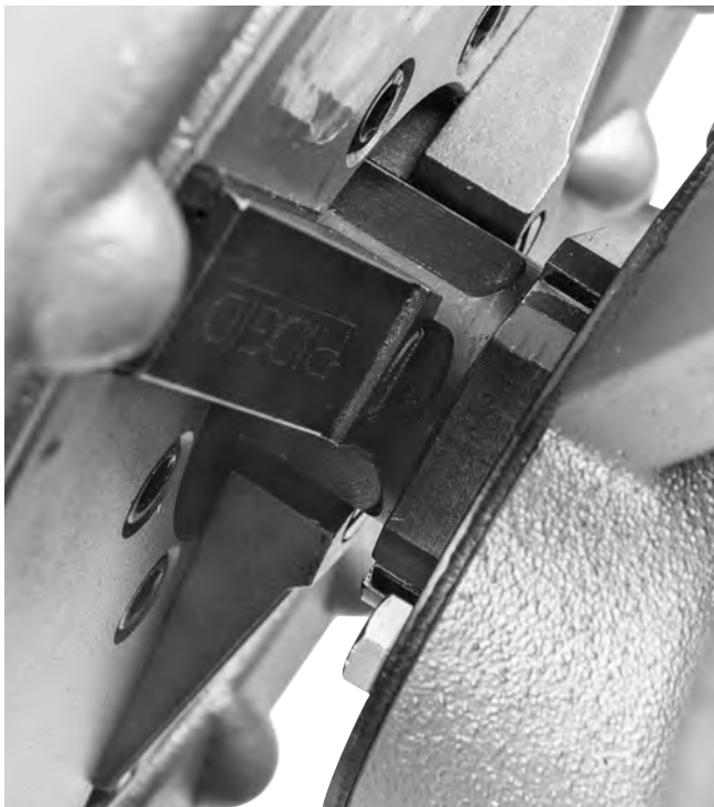
Figura 7 B – Conexión firme del eje de mando en el mandril
