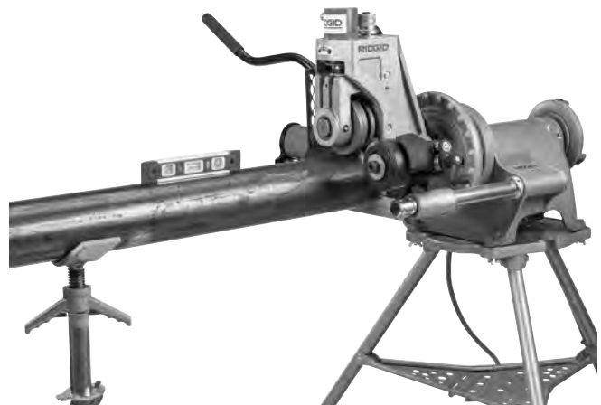
Figure 13 – Nivellement du tuyau
