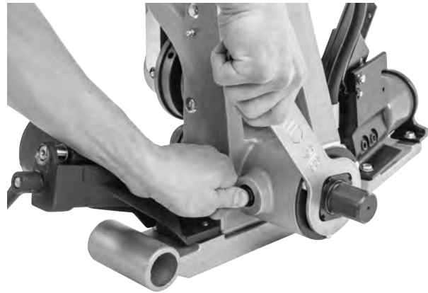
Figure 27 – Engagement de la broche de verrouillage et retrait de l'écrou de retenue de l'arbre de transmission
