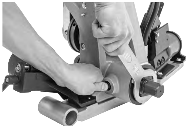
Figura 27 – Traba del husillo y extracción de la tuerca de retención del eje de mando
