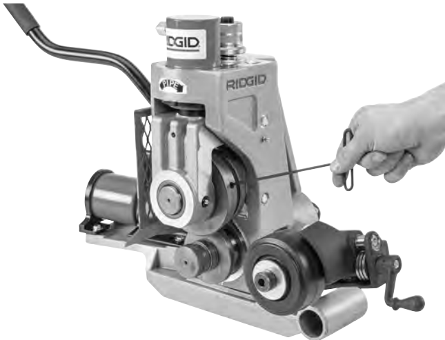
Figura 24 – Aflojar el tornillo de montaje del juego de rodillos ranuradores
