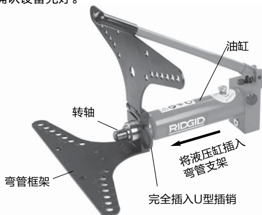
图5 - 组装2寸及3寸弯管机
