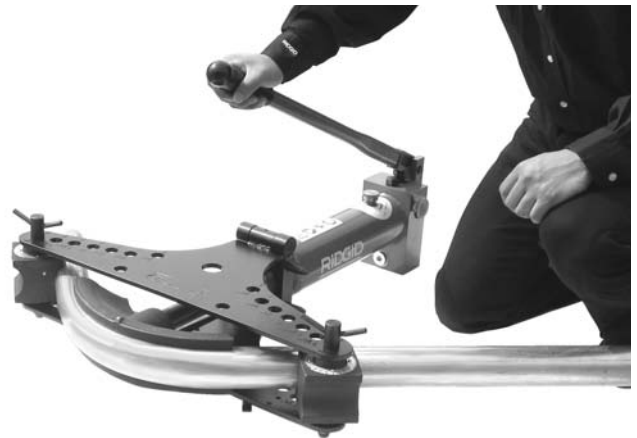
Figure 13 – Utilisation d'une cintreuse manuelle
