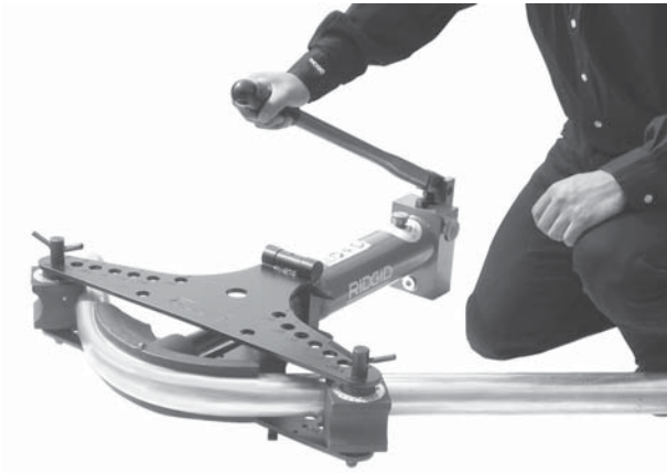
图13 - 手动液压弯管作业
