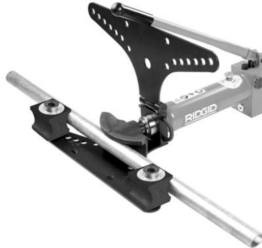
Figura 9 – Montaje del tubo
