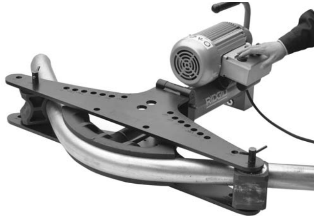
Figure 14 – Utilisation d'une cintreuse électrique
