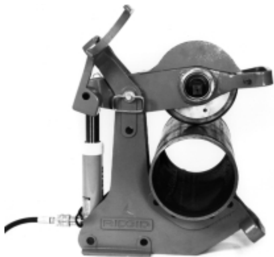
Figura 8 – Posición del tubo en el Cortatubos
