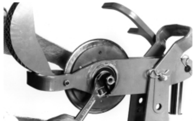
Figura 11 – Extraiga la tuerca de seguridad
