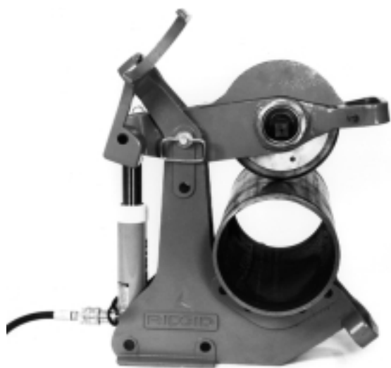
Figura 8 – Posición del tubo en el Cortatubos
