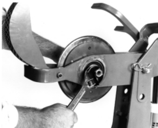
Figure 11 – Retrait de l'écrou de fixation
