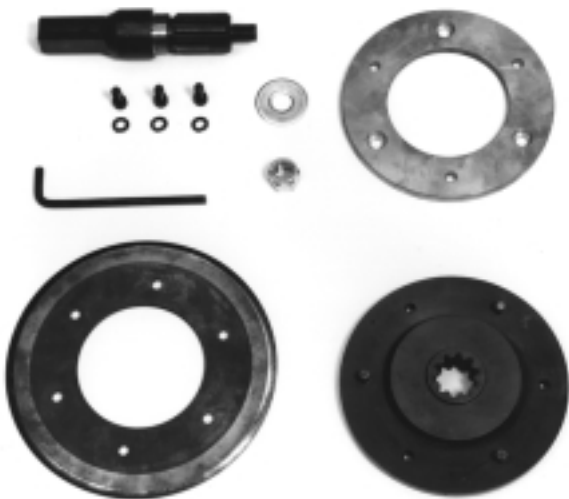
Figure 13 – Composants du disque de tronçonneuse
