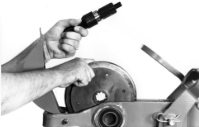
Figura 12 – Desmonte el conjunto de la rueda de corte
