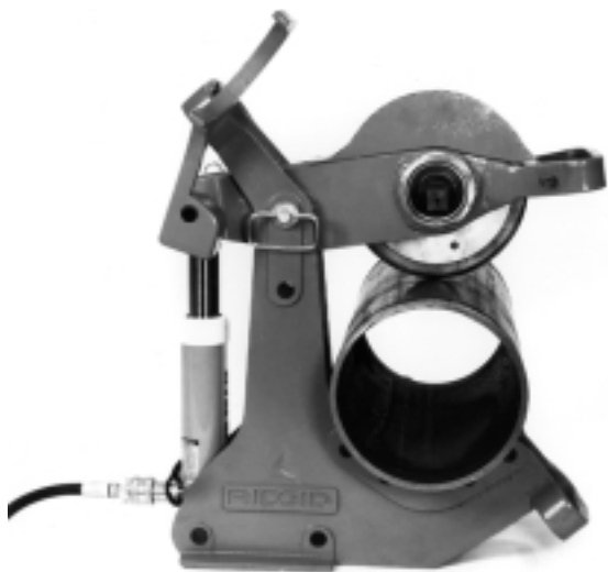
Figura 8 – Posición del tubo en el Cortatubos
