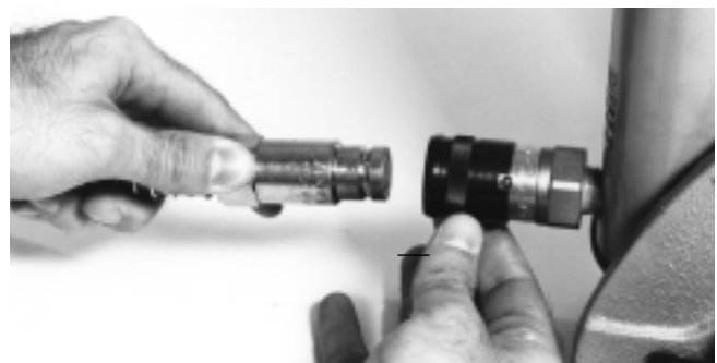
Figure 3 – Raccordement de la pompe à pédale hydraulique sur la tronçonneuse
