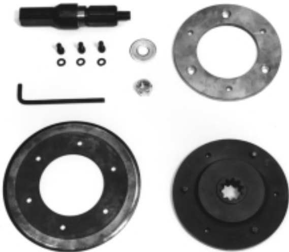
Figure 13 – Composants du disque de tronçonneuse
