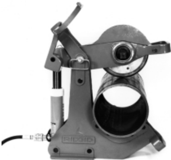
Figure 8 – Positionnement du tuyau sur la tronçonneuse
