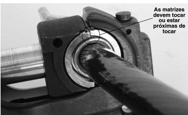
**Figure 8 – Inspeção das Matrizes assim que ativada a Válvula de Alívio de Pressão**
