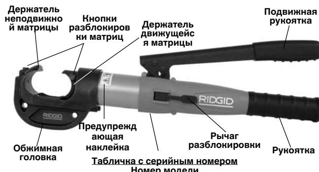
Рисунок 1 – Ручной гидравлический обжимной пресс RE 130-M/RE 12-M
