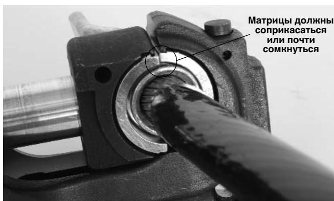
Рисунок 8 – Осмотр матриц после срабатывания предохранительного клапана давления
