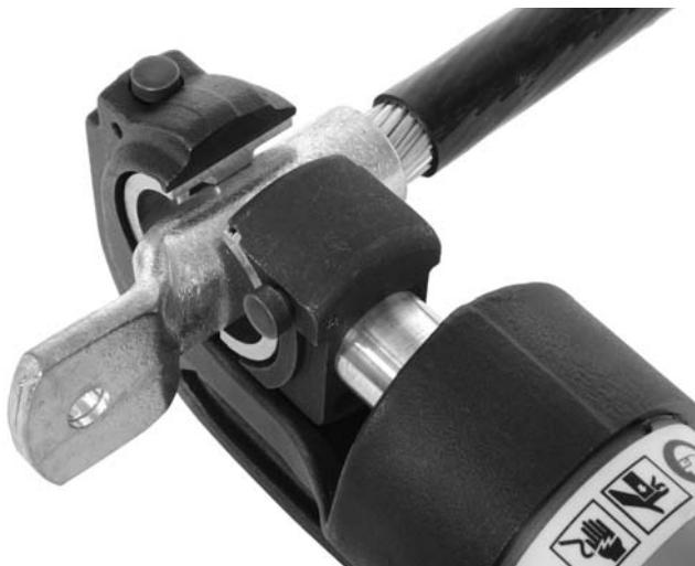
Рисунок 6 – Выравнивание соединителя
