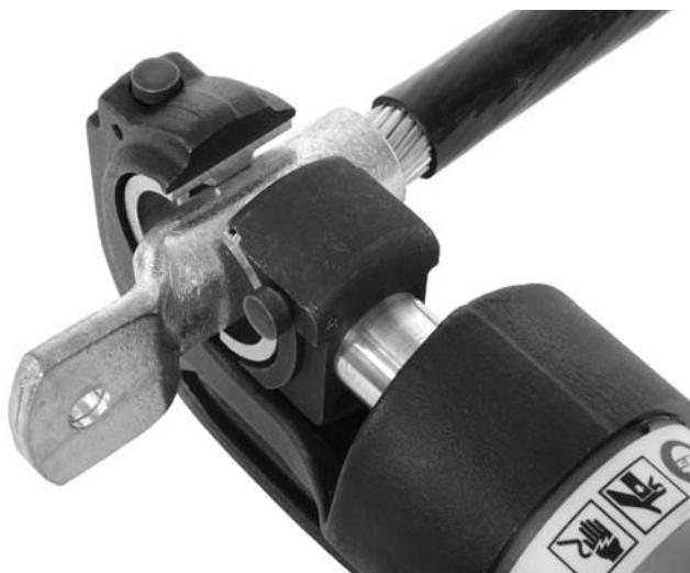
Figure 6 – Alignement du raccord
