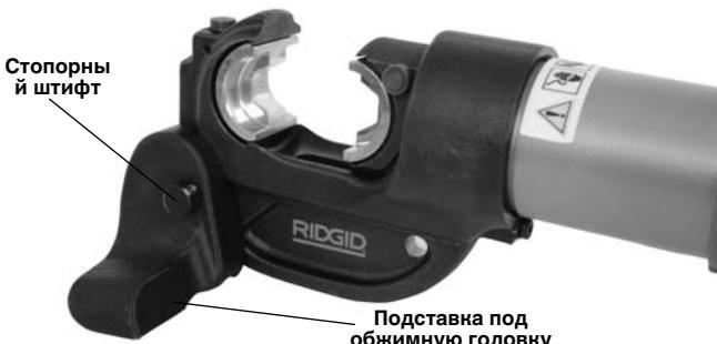
**Рисунок 5 – Установка обжимной головки на подставку**
