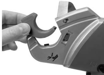
Figura 7 – Instalación del adaptador de soporte, el cual permite cortar tubos de varias capas
