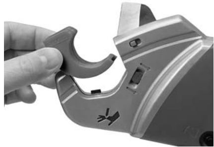
Figure 7 – Montage de l'adaptateur pour tuyaux à parois multiples
