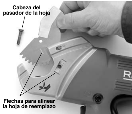
Figura 12 – Extracción e instalación de una hoja de corte
