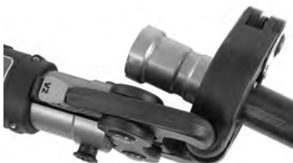
Figure 12B – Engagement à 90° de l'actionneur dans la bague MegaPress en cas de manque de refuite
