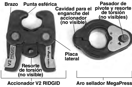
Figura 2 – Aro y accionador MegaPress
