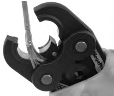
Figure 13 – Nettoyage des axes d'une mâchoire MegaPress
