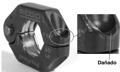
Figura 11 – Cavidad dañada en el aro
