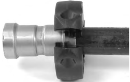
Figura 10 – Apertura del aro MegaPress para colocarlo sobre el acoplador
