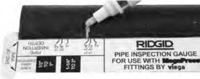
Figura 6B – Valiéndose de un calibre MegaPress® de RIDGID®, marque hasta dónde debe insertarse el tubo dentro del acoplador
