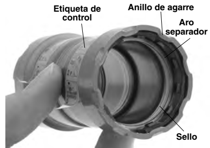
Figura 5 – Inspección del acoplador MegaPress antes de introducirle un tubo
