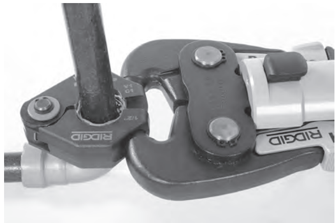
Abbildung 12 – Ansetzen des Stellantriebs am Pressring
