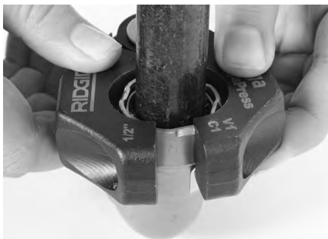
Figure 11 – Engagement de la bague de sertissage sur le raccord
