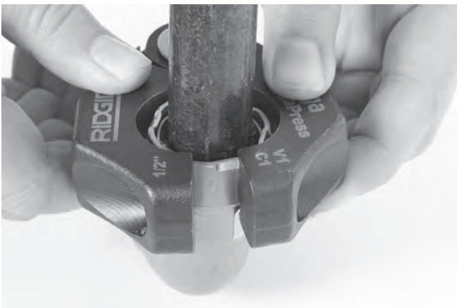
Abbildung 11 – Anbringen des Pressrings am Fitting
