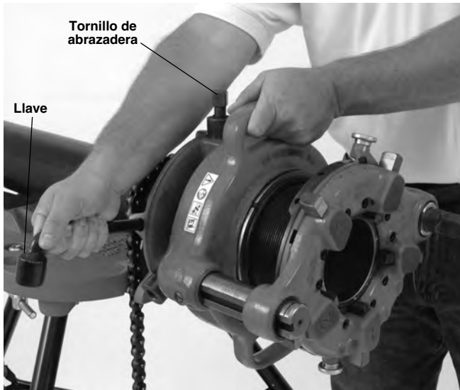
Figura 6 – Cómo apretar el portaherramientas
