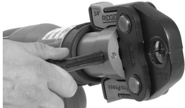
Figura 4 – Retire hasta atrás el pasador para el montaje del accesorio (mordazas)
