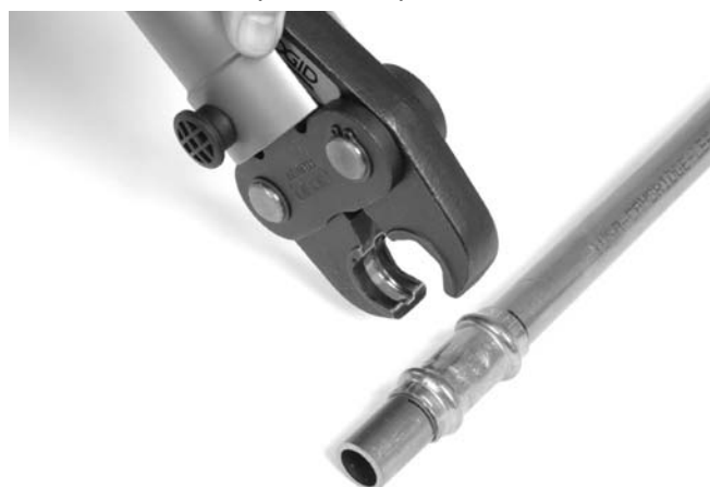
Figura 6 – Apertura de las mordazas tipo tijeras
