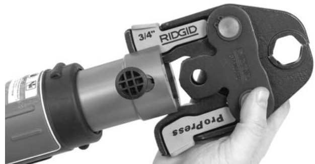
Figura 5 – Coloque el accesorio (mordazas) en la nariz de la Selladora
