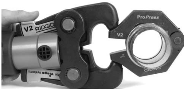
Figura 10 – Montaje del accionador al aro sellador
