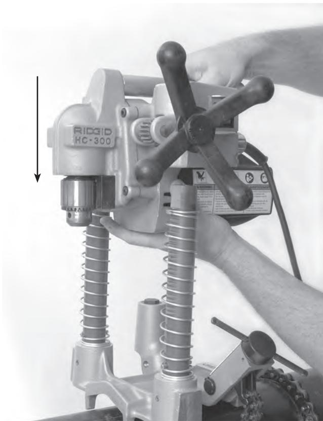
図 9 - HC-300 モーターアセンブリのベースアセンブリへの取り付け
