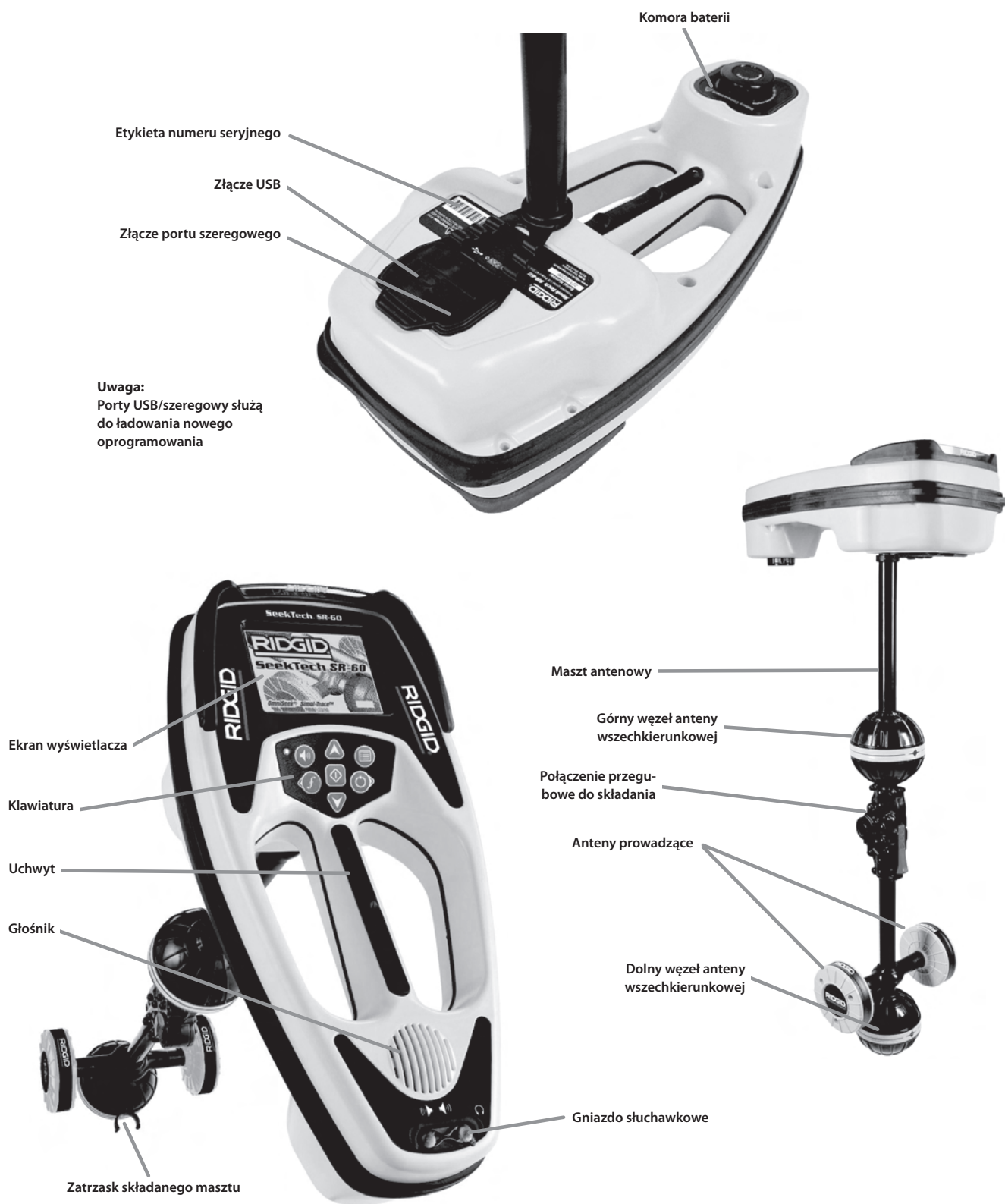
Rysunek 1: Części składowe SR-60
