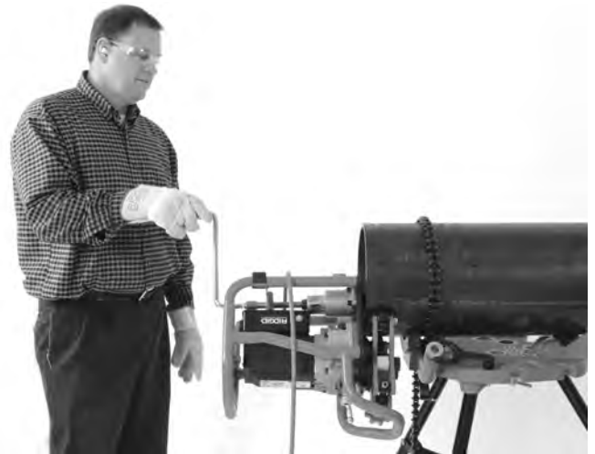
Figura 20B – Operación de biselado (pieza fija/biseladora móvil)
