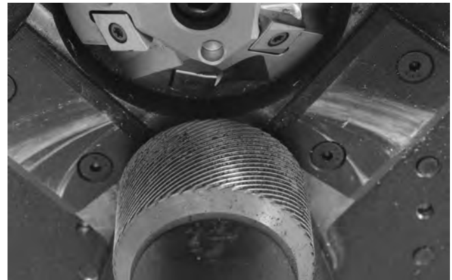
Figura 22 – Superficie moleteada del rodillo de mando, limpia
