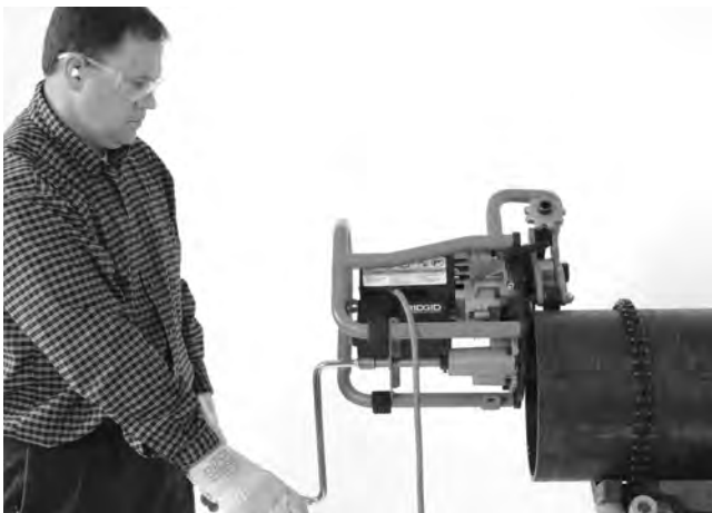
Figura 20A – Operación de biselado (pieza fija/biseladora móvil)
