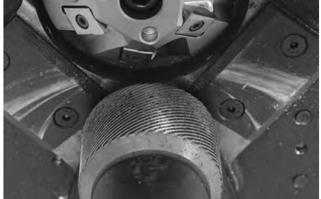
Figure 22 – Nettoyage du moletage du galet d'entraînement
