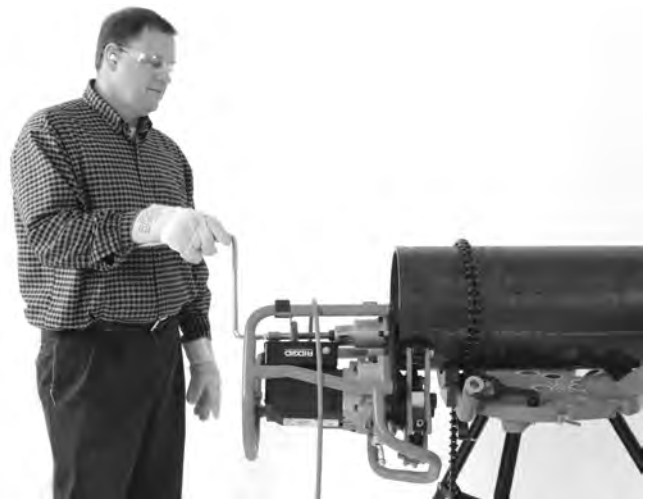
Figure 20B – Biseautage en cours (pièce fixe/machine mobile)
