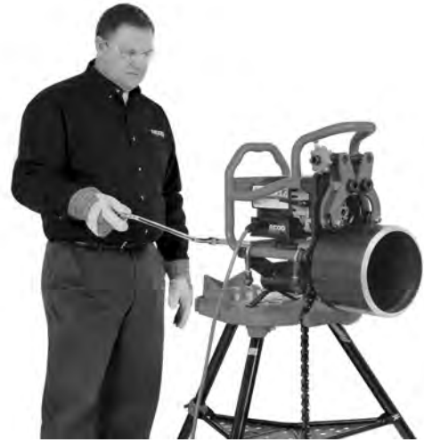
Figura 20C – Operación de biselado (biseladora fija/tubo en rotación)
