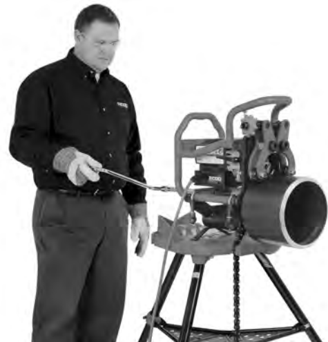
Figure 20C – Biseautage en cours (machine fixe/tuyau mobile)
