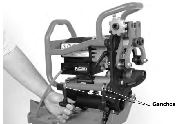
Figura 9 – Conexión de la biseladora con el adaptador
