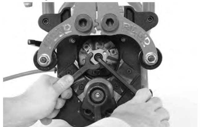
Figure 25A – Changement des têtes de coupe
