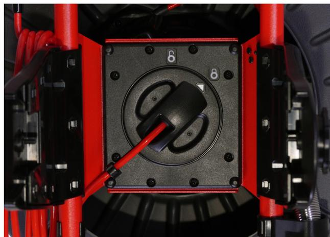
3. Enganche el cable del sistema en el gancho del cuadro y encaje el anclaje del cable en el cuadro.
